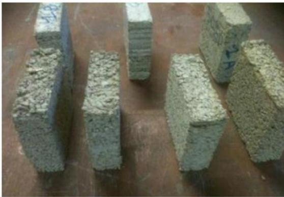
(a) échantillons de béton de liège
