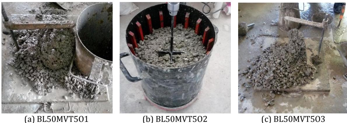
**Figure 4.4.** Influence de l’ordre d’introduction sur l’homogénéité du béton de liège.
