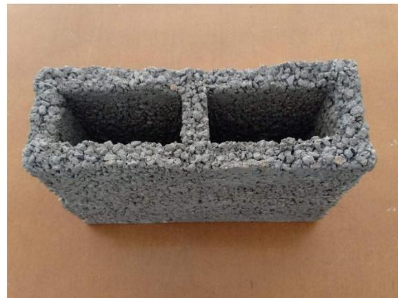
(b) Parpaing en béton de liège (source :
