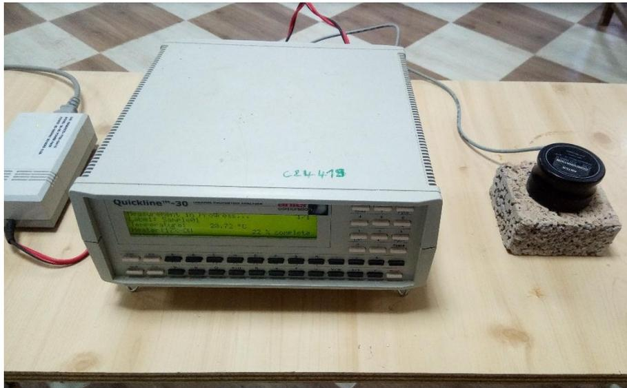
**Figure 3.17.** Mesure de la conductivité thermique à l'aide du QUICKLINE-30 (Laboratoire LABMAT, Ecole Nationale Polytechnique d'Oran).
