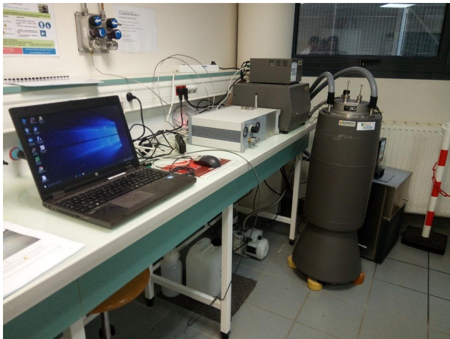
Figure 3.19. Dispositif de mesure de la chaleur spécifique (Laboratoire LaSIE, La Rochelle Université).
