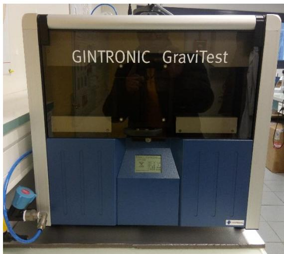
(a) Dispositif de mesure Gintronic GraviTest
