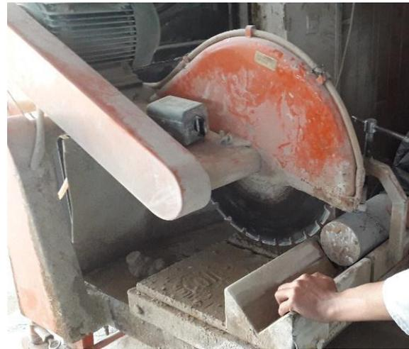
**Figure 3.15.** Surfaçage des éprouvettes de béton de liège.
