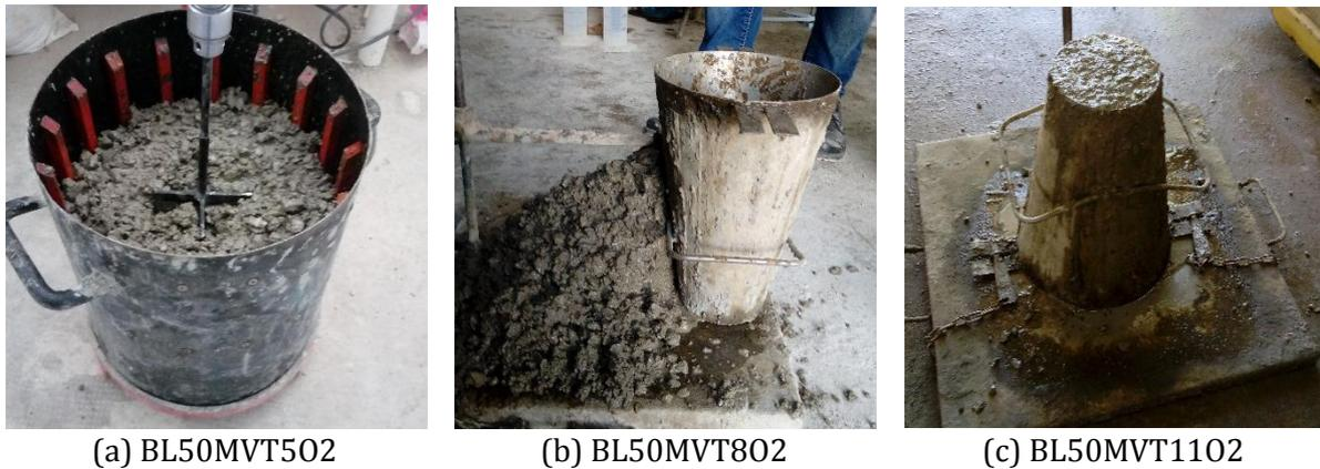
**Figure 4.7.** Influence du temps de malaxage sur l'homogénéité du béton de liège.
