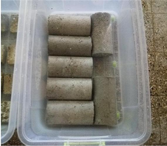
**Figure 3.14.** Conservation des éprouvettes de béton de liège.
