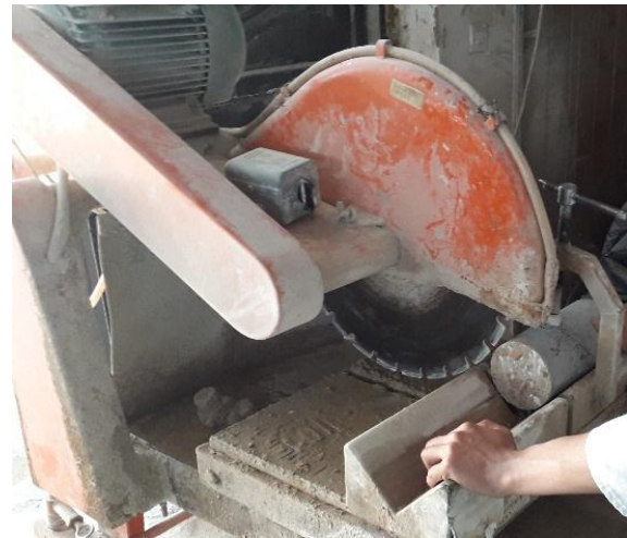
Figure 3.15. Surfaçage des éprouvettes de béton de liège.
