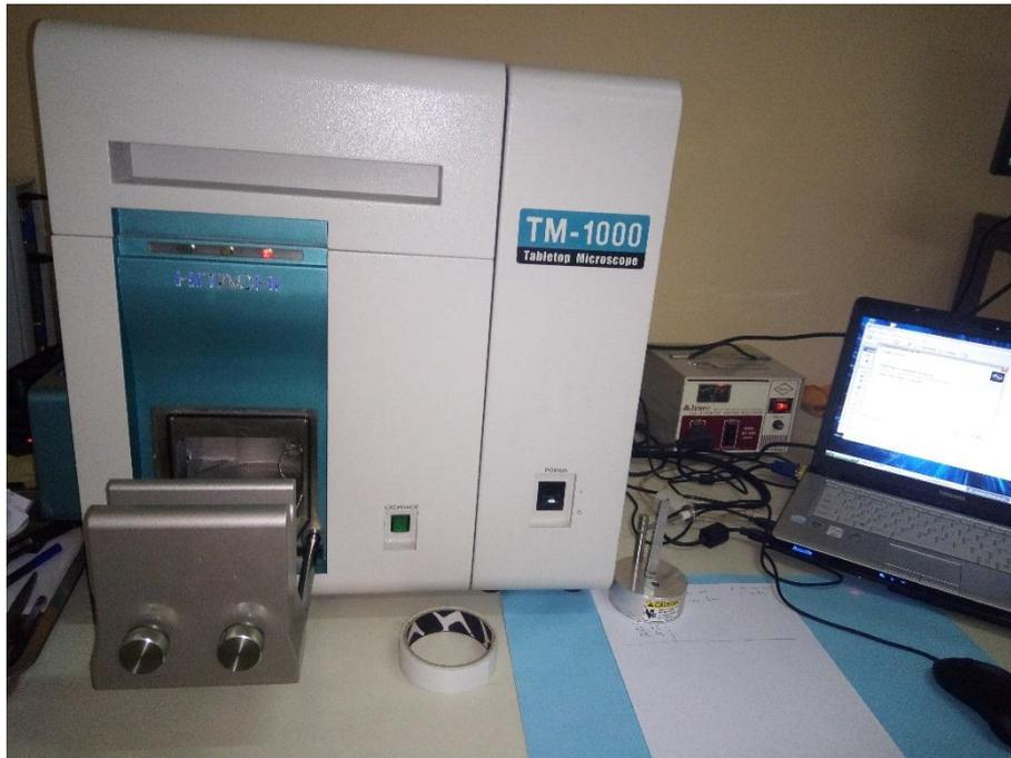
**Figure 3.28.** MiniMEB de paillasse Hitachi-TM1000 (Laboratoire LRM, Faculté des sciences, Université de Tlemcen).
