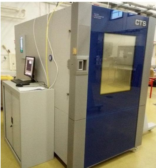
(a) enceinte climatique utilisée pour la mesure de la MBV
