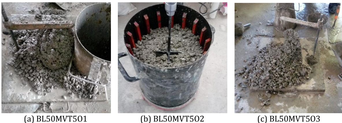
Figure 4.4. Influence de l’ordre d’introduction sur l’homogénéité du béton de liège.
