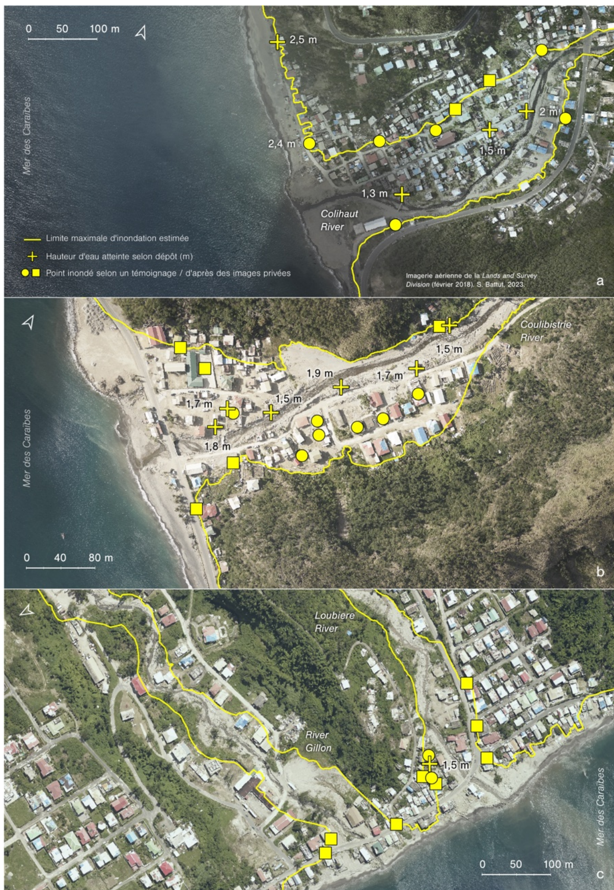
Figure 61 – Enveloppes d'inondation de l'ouragan Maria reconstituées d'après diverses sources à Colihaut (a), Coulibistrie (b) et Loubiere (c). En occupant le front de mer et le lit majeur de fleuves torrentiels dans des vallées côtières encaissées, les enjeux sont très largement exposés aux aléas cycloniques dans ces villages.
