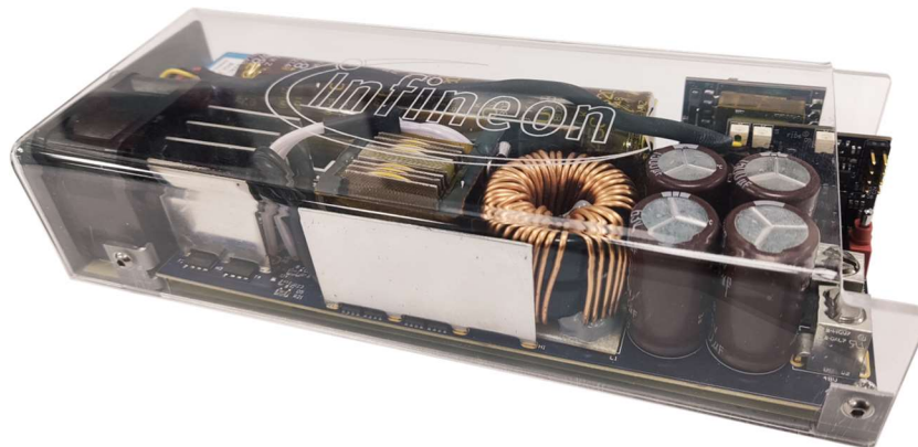
Figure 4-6 : Carte d'évaluation PSFB Infineon 3300 W
