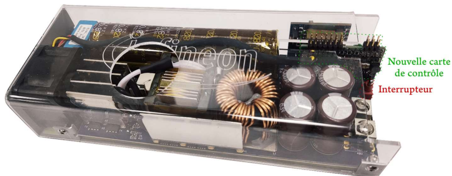
Figure 4-14 : Carte d'évaluation PSFB Infineon avec la nouvelle carte de contrôle
