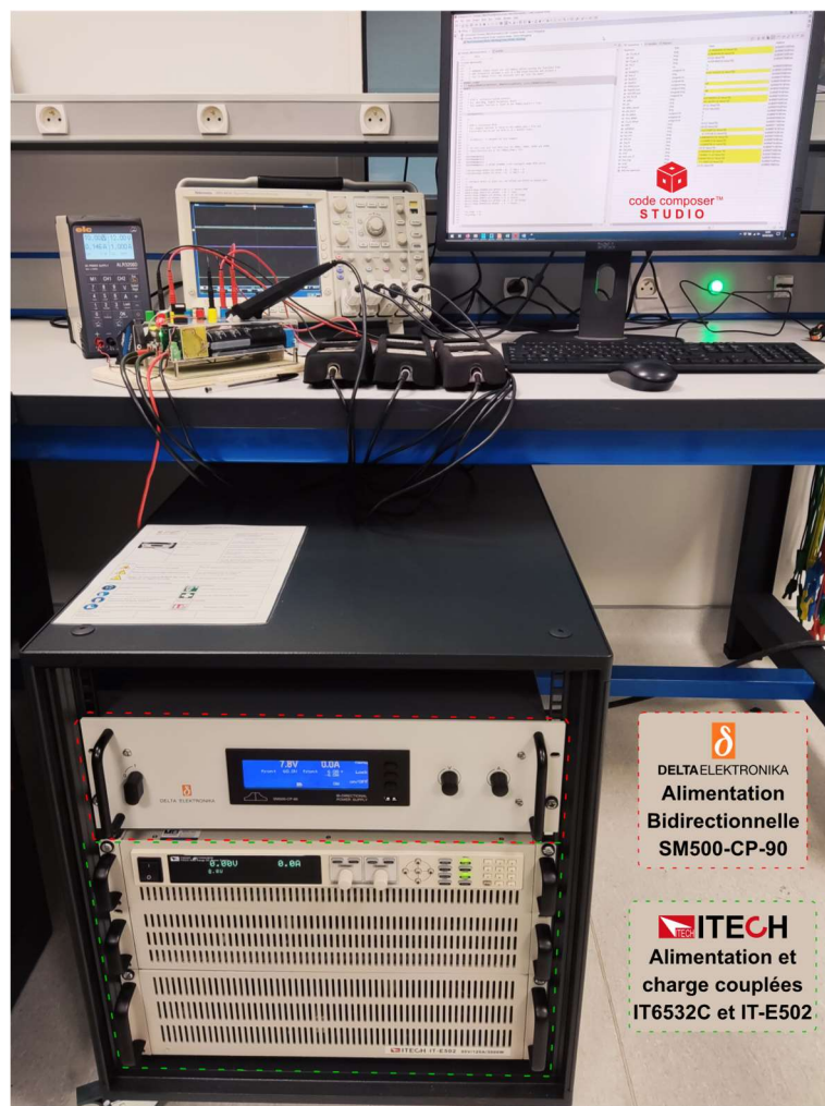
Figure 4-15 : Configuration de test de la carte d'évaluation PSFB Infineon (alimentations électroniques)
