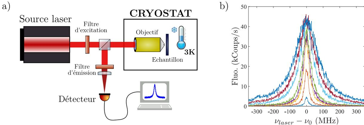
FIGURE 1.6 – **Spectroscopie d’excitation d’une molécule unique.** a) Schéma d’un montage expérimental pour la spectroscopie d’excitation ; b) Spectres d’excitation d’une molécule individuelle pour différentes puissances d’excitation, allant de 0.2 à 200 nW. Le bin des spectres est de 1 MHz et le temps d’intégration par point de 25 ms.
