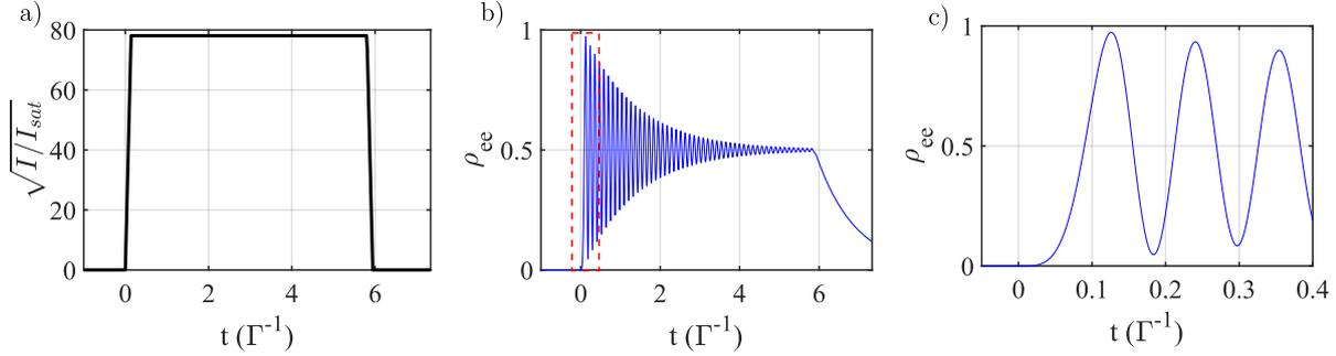
FIGURE 3.4 – **Oscillations de Rabi tenant compte du temps de monté de 750 ps de l'EOM.** L'échelle des temps est normalisée avec  $\Gamma = 2\pi \times 22.2$  MHz (valeur moyenne de la largeur spectrale des molécules étudiées). **a)** Impulsion tenant compte du temps de montée de l'EOM ( $I_{laser} = 6100 I_{sat}$ ); **b)** Simulation de la fluorescence associée à l'impulsion en panneau **a**); **c)** Zoom sur la partie encadrée du panneau **b**).
