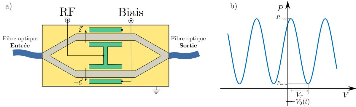
FIGURE 2.8 – **Modulateur électrooptique.** a) Schéma de fonctionnement du modulateur d'intensité électro-optique (EOM) ; b) Fonction de transfert de l'EOM, P désigne la puissance laser en sortie de ce dernier.
