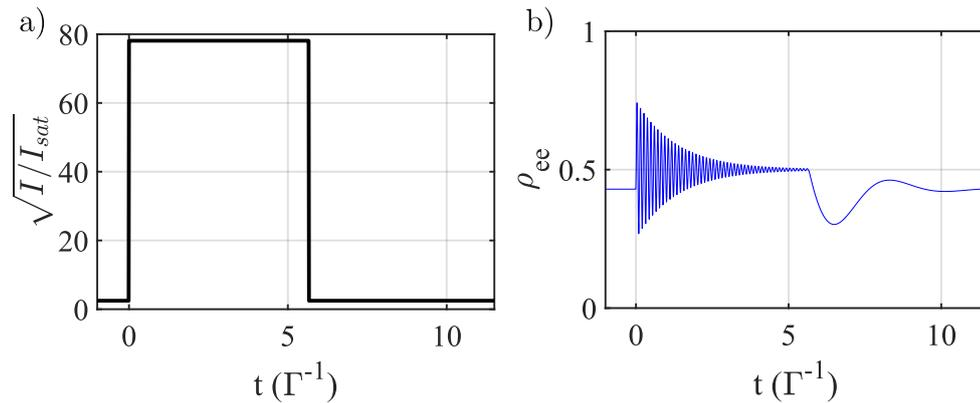
FIGURE 3.3 – **Prise en compte du taux d'extinction fini de l'EOM.** **a)** Modèle d'impulsion avec un taux d'extinction  $\kappa = 1000$ , pour une intensité d'excitation de  $I_{laser} = 6100 I_{Sat}$ ; **b)** Simulation de l'évolution de la fluorescence associée à l'impulsion en panneau **a**).
