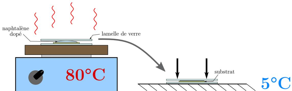
FIGURE 2.14 – **Schéma de la fabrication des échantillons.** La plaque chauffante permet de porter le naphthalène à sa température de fusion. Les flèche noires indiquent que la lamelle de verre est compressée pendant la cristallisation du naphthalène.
