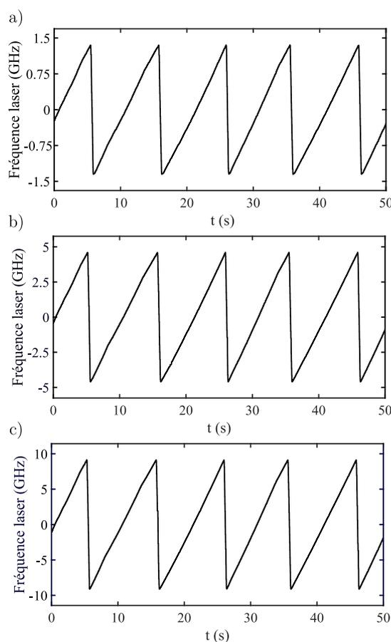
FIGURE 2.2 – **Fréquence mesurée au cours d'un scan du laser.** Le calibre utilisé est de **a)** 3 GHz ; **b)** 10 GHz ; **c)** 20 GHz. Le balayage de la fréquence (pente montante) est réalisé en 1000 pas de fréquence, chacun d'une durée de 10 ms. Le temps d'exposition du lambdamètre est de 10 ms, valeur typique que nous utilisons pour effectuer les spectres d'excitation.
