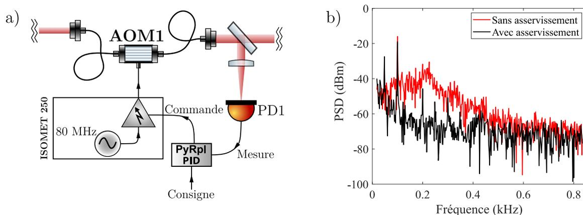
FIGURE 2.4 – **Asservissement de la puissance laser.** a) Schéma de fonctionnement de l’asservissement de la puissance du laser ; b) Comparaison de la densité spectrale de puissance (PSD) du laser avec et sans asservissement, mesurée avec une photodiode NewFocus 1607-AC-FS (bande passante 600 MHz) et un oscilloscope Teledyne LeCroy Wavesurfer10 (bande passante 1 GHz).
