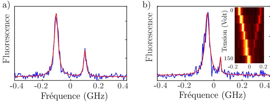
FIGURE 5.8 – Spectres d'excitation d'une paire de molécules couplées ( $V \approx \Gamma_0$ ), en configuration J, excitée en régime non-saturé ( $I_{\text{laser}} = 0.25 \text{ W.cm}^{-2}$ ). **a)** Tension de 0 Volt appliquée aux électrodes, correspondant à  $\delta = 10\Gamma_0$ ; **b)** Tension de 150 Volt appliquée aux électrodes, correspondant à  $\delta = 4\Gamma_0$ . L'insert représente l'évolution du spectre entre 0 et 150 Volt.
