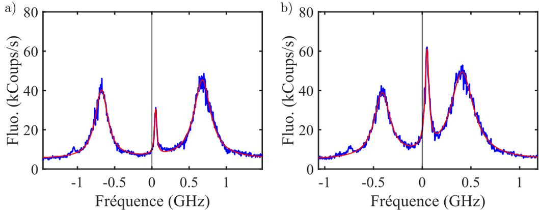
FIGURE 5.16 – **Décalage vers le bleu de la transition à deux photons.** a) Spectre d'excitation d'une paire de molécules de DBATT piégées dans du naphthalène ( $V = 9.5\Gamma_0$ ). La puissance d'excitation est de 500 nW et le degré d'intrication vaut  $P_E = 0.45$ ; b) Idem avec un degré d'intrication de  $P_E = 0.7$ ; Dans les deux cas la transition à deux photons est décalée de 50 MHz vers le bleu.
