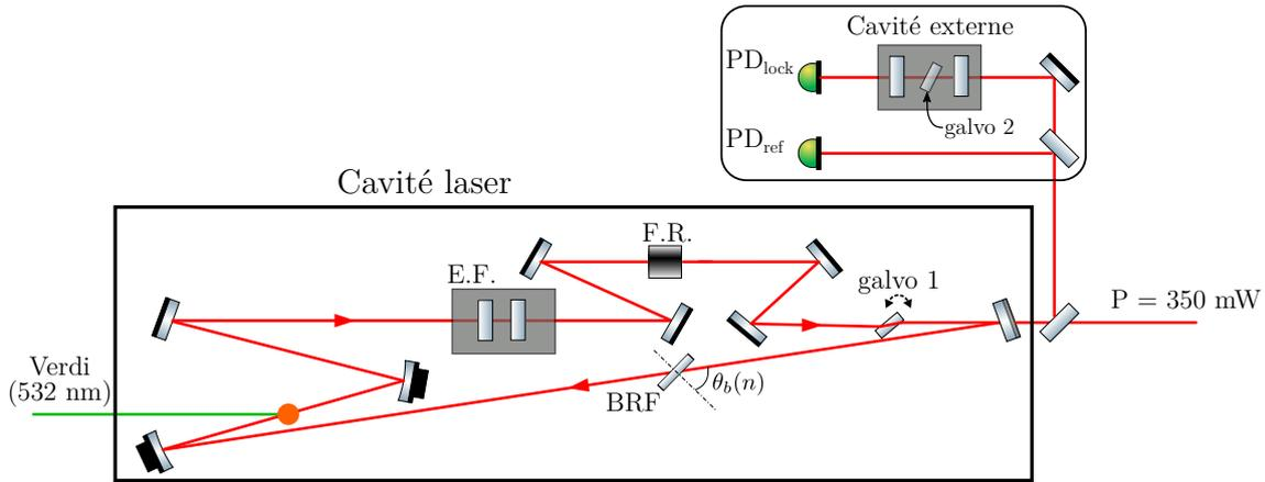
FIGURE 2.1 – Schéma de principe du fonctionnement de notre laser à colorant. Les flèches rouges indiquent le sens de propagation de la lumière dans la cavité. Ce sens sera qualifié de *propagatif*, à opposer au sens *contrapropagatif* (voir texte).
