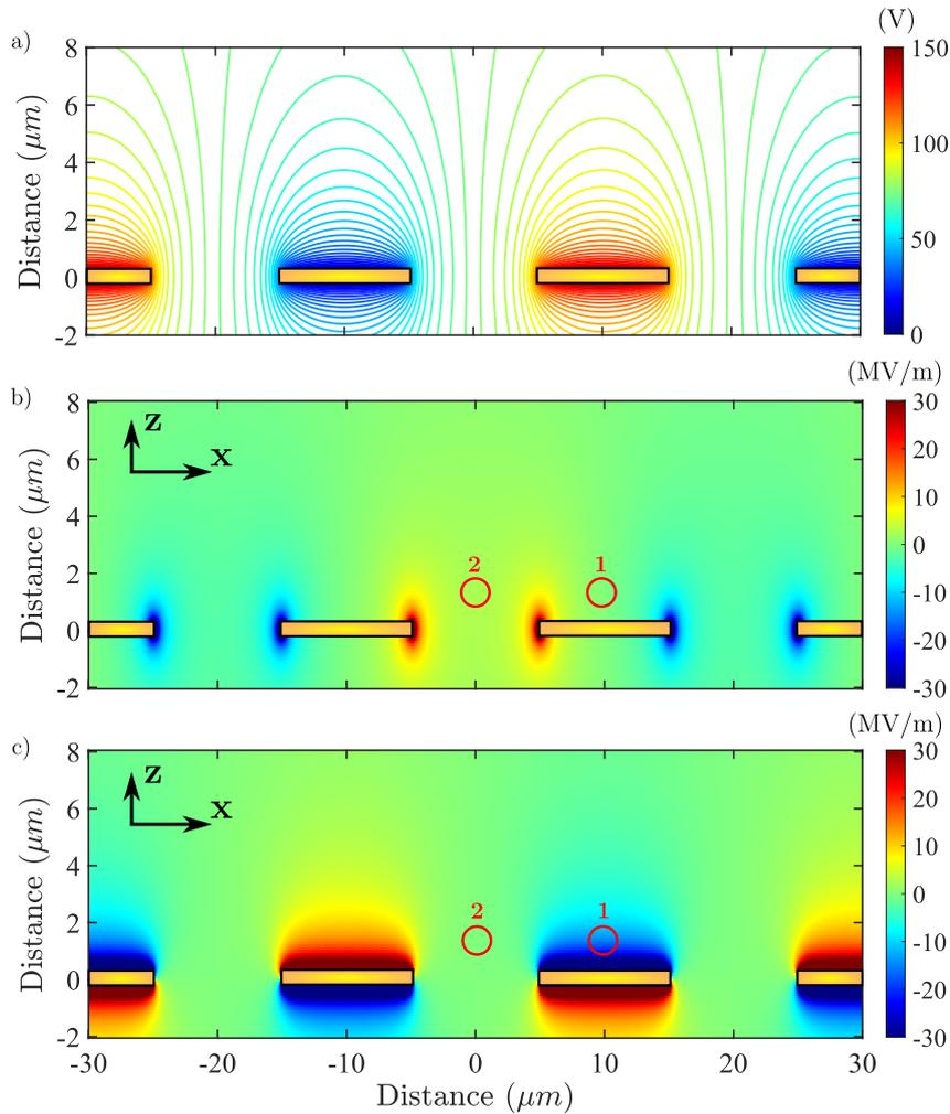
FIGURE 2.13 – **Analyse du champ généré par les électrodes.** a) Calcul du potentiel électrique généré par les électrodes pour l’application d’une tension de  $V_{Stark} = 150$  Volt. Les électrodes sont représentées par les rectangles dorés ; b) Champ électrique suivant l’axe x ; c) Champ électrique suivant l’axe z.
