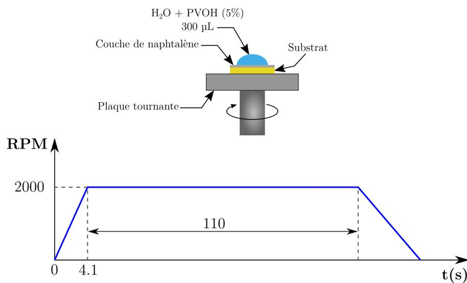
Une goutte de 300 µL d'une solution de PVOH concentrée à 5% en masse est déposée, à l'aide d'une micropipette, sur la couche de naphthalène cristallisé. Le programme de spincoating est montré sur le graphe ci-dessus. La plaque tournante accélère de 0 à 2000 tr/min en 4.1 s et maintient sa vitesse pendant 110 s afin que l'intégralité de l'eau s'évapore.
