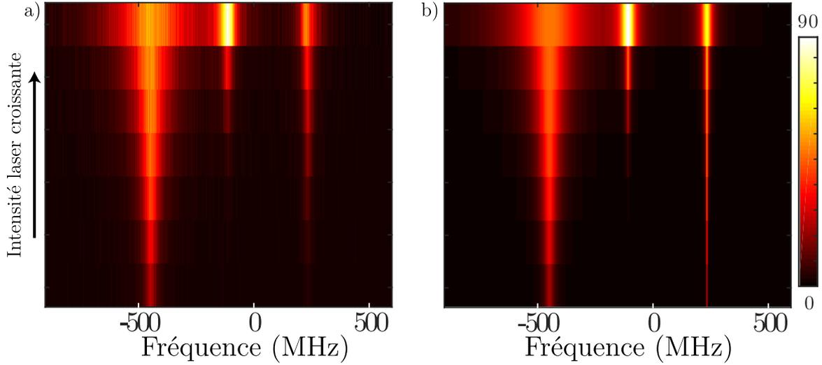
FIGURE 5.3 – **Détermination de la constante de couplage.** a) Série de spectres d'excitation d'une paire de molécules couplées pour différentes intensités laser, de  $2 \text{ W.cm}^{-2}$  à  $250 \text{ W.cm}^{-2}$ . L'excitation est faite à l'aide du faisceau gaussien  $TEM_{00}$ ; b) Solution de l'équation maîtresse après ajustement sur les données expérimentales en panneau a).
