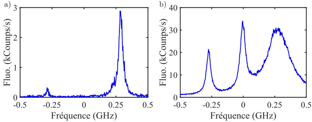
FIGURE 5.10 – Spectres d’excitation de deux molécules couplées, quasi-parallèles en configuration **H**. a)  $P_{laser} = 1$  nW avec un faisceau d’excitation gaussien en polarisation linéaire ; b)  $P_{laser} = 500$  nW. En étudiant l’évolution du spectre d’excitation en fonction de l’intensité laser, on obtient les paramètres suivant :  $\Gamma_0 = 22$  MHz  $V \approx 15\Gamma_0$ ,  $\Gamma_{12} \approx 0.3\Gamma_0$ ,  $\delta = 4\Gamma_0$  ( $P_E \approx 0.98$ ).
