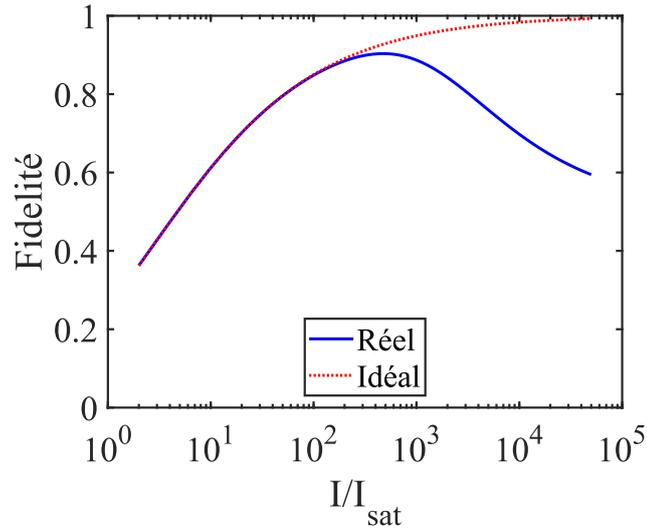
FIGURE 3.5 – Simulation de la fidélité des oscillations de Rabi en fonction du rapport de saturation dans le cas idéal et réel (pour le cas réel,  $\kappa = 1000$ , temps de montée des impulsions de 750 ps).
