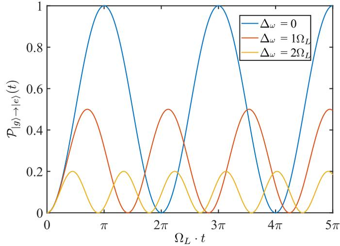
FIGURE 3.1 – Oscillations de Rabi simulées pour différents désaccords.
