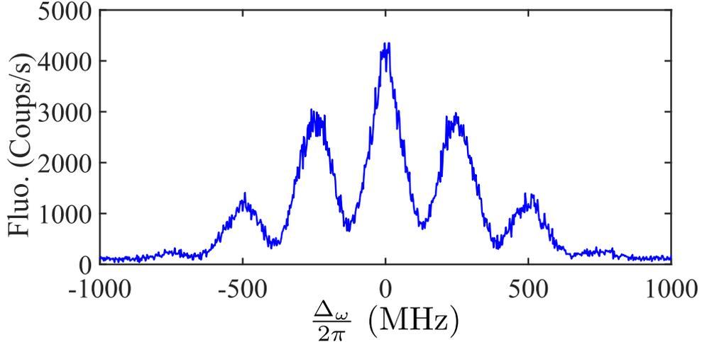
FIGURE 3.20 – **Spectre d'excitation enregistré en excitant la molécule avec une séquence de Ramsey.** Avec  $\tau = 2.7$  ns,  $T = 1$  ns, le temps d'intégration par point est de 10 ms moyenné sur 20 spectres, et la résolution vaut 3 MHz.
