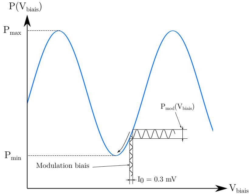
FIGURE 2.10 – Effet de la modulation de la tension biais sur la puissance laser en sortie de l’EOM. L’amplitude de modulation laser  $P_{\text{mod}}$  est dépendante la tension biais  $V_{\text{biais}}$  et est minimale au niveau des extréma locaux de la fonction de transfert.
