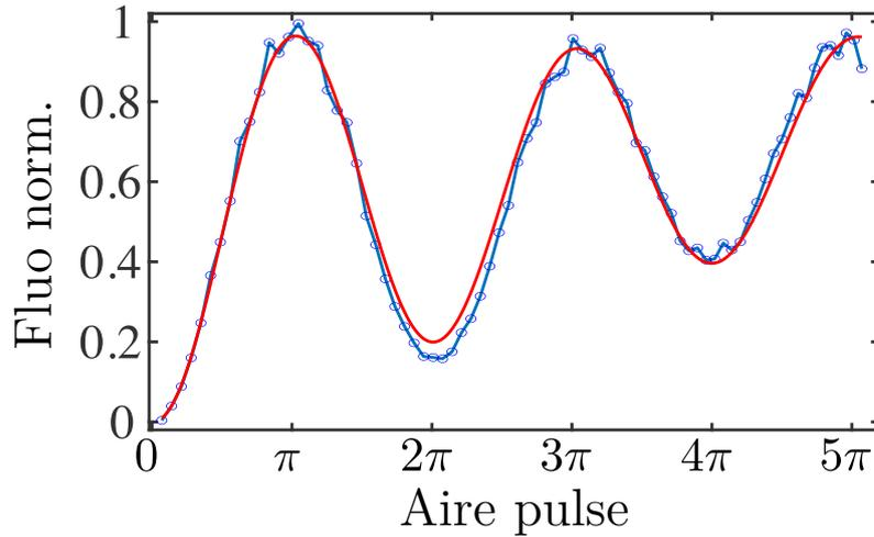
FIGURE 3.16 – **Manipulation optique contrôlée.** Fluorescence intégrée à la suite de chaque impulsion “bleue” et normalisée par rapport à la fluorescence intégrée après une impulsion “rouge”. Le temps d’intégration du signal est de 700 s, la résolution de 256 ps et le fond, mesuré 10 GHz hors résonance, a été soustrait. L’aire des impulsions est obtenue en ajustant sur les données, un modèle empirique de sinusöide amortie porté sur un fond linéaire (ligne rouge) [131].
