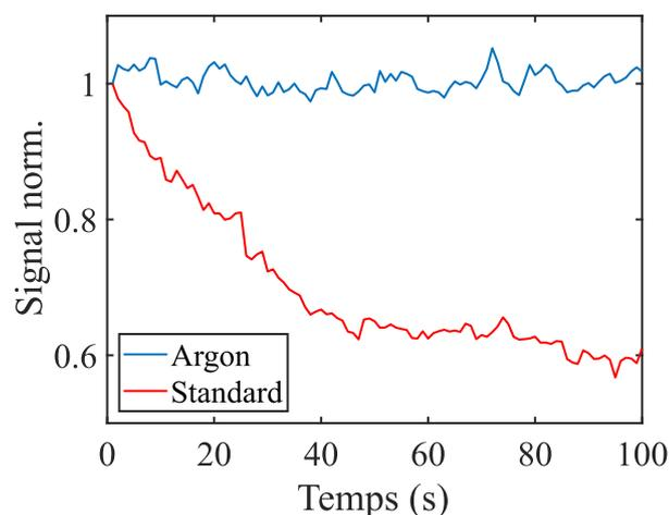
FIGURE 2.20 – Trace temporelle de la fluorescence intégrée sur une image de  $40 \times 40 \mu\text{m}^2$  avec la procédure standard de mise à froid et notre procédure spéciale utilisant une atmosphère d'argon. Temps d'intégration par image de 1 seconde.
