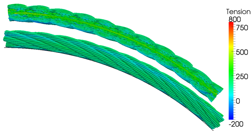
FIGURE 4.9 – Visualisation des contraintes longitudinales dans les fils du câble tendu et fléchi sur un cylindre pour un échantillon de longueur 60 mm : vue latérale (en bas) et coupe (en haut)
