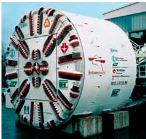
Figure 3 : Bouclier d'une machine à attaque pleine section (tunnelier utilisé pour le Botlekspoor tunnel, aux Pays-Bas, d'après Herrenknecht AG (1))
