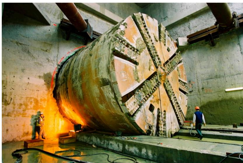
**Figure 78 : Tunnelier à pression de boue du lot 4 en station (station Empalot)**
