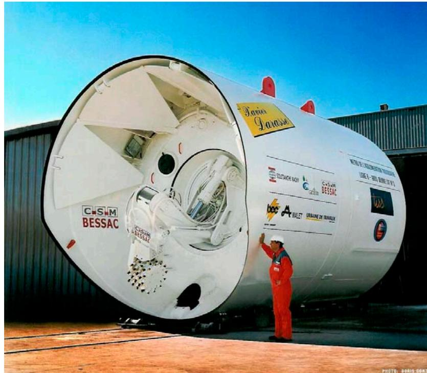
Figure 76 : Tunnelier à pression d'air utilisé pour le creusement du tunnel du lot 3
