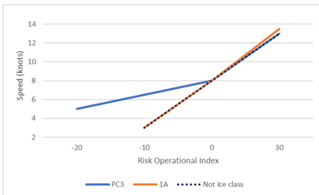
Figure 7.9 – Courbe de vitesses de 3 navires de classes glace différentes (Not Ice Class, 1A, PC3) en fonction de l'indice de risque POLARIS.
