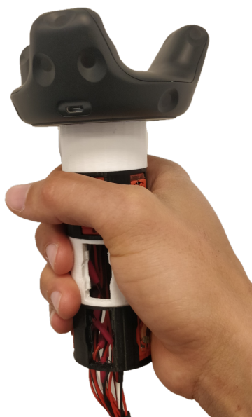
FIGURE 5.8 – Prototype tenu en main. On peut observer la zone non couverte par la main sous le pouce.
