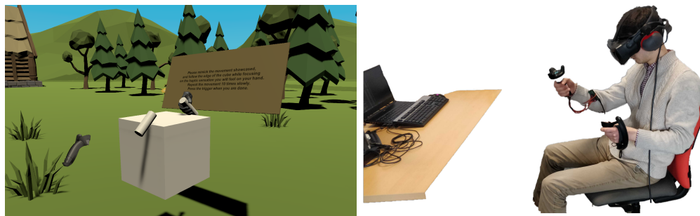
FIGURE 5.12 – Vue de l'environnement virtuel de la troisième expérience et de la manette interagissant avec le cube, avec la main animée sur l'arrière du cube (à gauche), et participant avec le dispositif expérimental - casque de RV, casque antibruit, et manettes (à droite).
