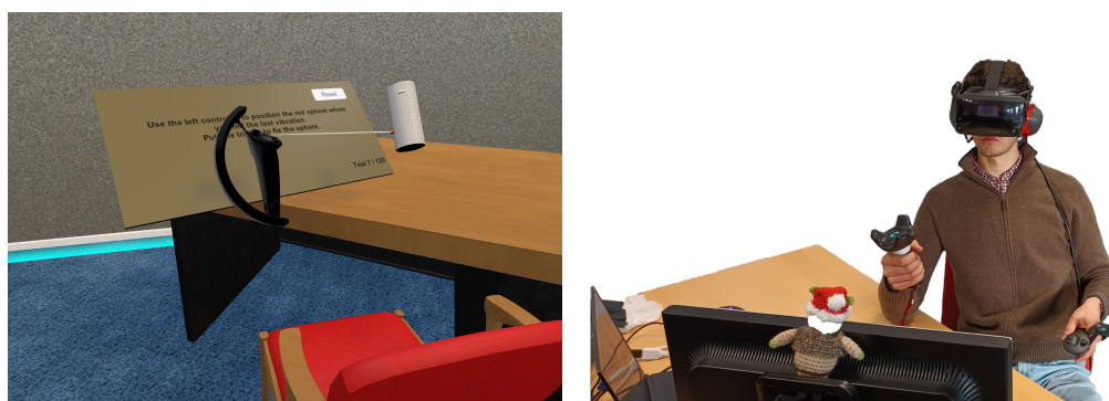
FIGURE 5.4 – Vue de l'environnement virtuel de la première expérience et du protocole de réponse - positionnement de la vibration (à gauche), avec le dispositif expérimental - casque de RV, casque antibruit, et manettes (à droite).
