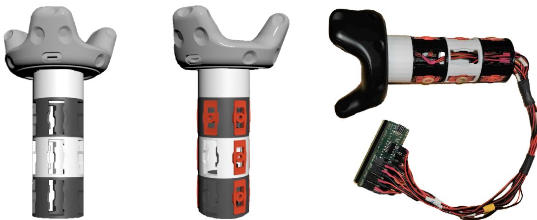
FIGURE 5.1 – Vues du prototype. À gauche, le modèle du châssis formé par les 3 modules pour vibreurs, le chapeau et le Vive Tracker . Au milieu, le modèle avec les vibreurs. À droite, le prototype et la carte électronique.
