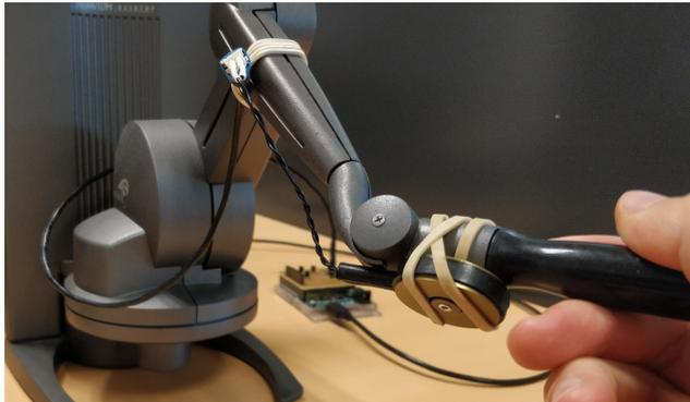
**FIGURE 4.4 – Dispositif expérimental : le périphérique haptique *Phantom Desktop* en gros plan, avec à la base du stylet le vibreur *C2 tactor* et la carte électronique *Arduino Leonardo* en arrière-plan.**
