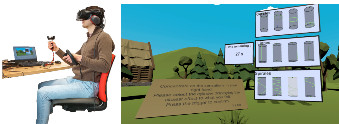
FIGURE 5.9 – Dispositif expérimental, avec le casque de RV, la manette prototype, la manette Valve Index, et le casque de réduction de bruit (gauche), et l’environnement virtuel avec les différents motifs (droite).
