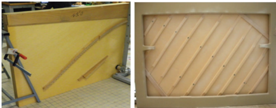
FIGURE 1.7 – Table d’harmonie non cordée d’un piano Pleyel P131 pour les mesures aux vibromètres laser à balayage côté chevalets (à gauche) et côté raidisseurs (à droite). Tiré de [RI7].
