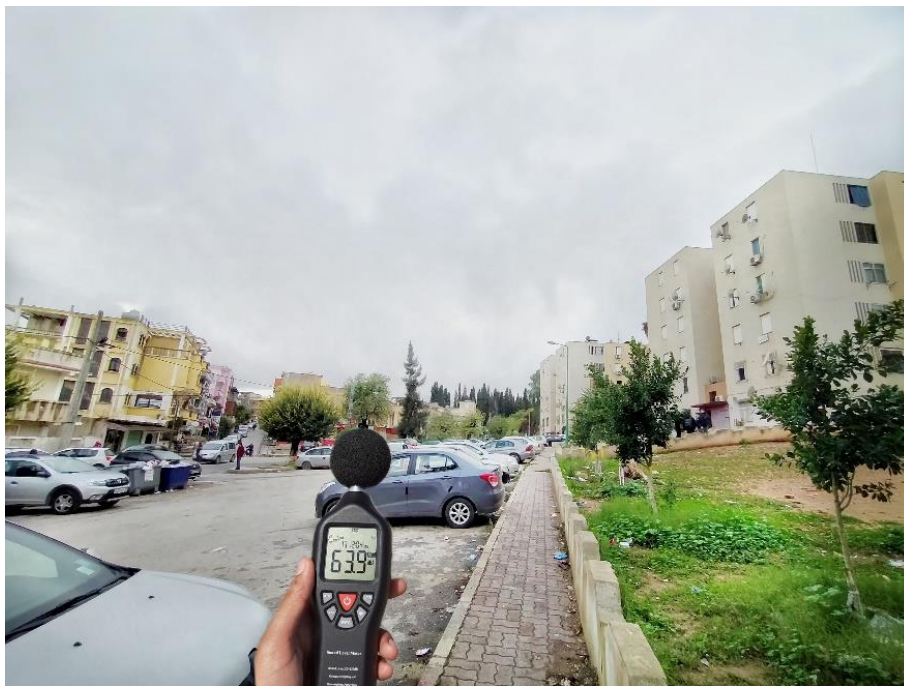
Figure 60 : Mesurage préliminaire directe en temps réel de niveau LAeq,1min. Source : Auteur, 2019
