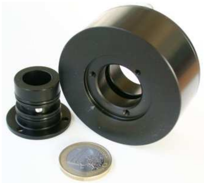
FIG. L.4 – Coupleur avec quatre tubes cylindriques en paroi.
