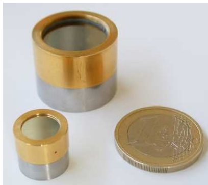
FIG. M.3 – Microphones étalons de laboratoire (à l'avant Brüel & Kjær 4180, à l'arrière Brüel & Kjær 4160).
