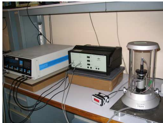
FIG. M.4 – Banc d'étalonnage en usage au LNE (de gauche à droite : l'analyseur vectoriel, l'appareil de réciprocité, l'afficheur de la sonde de température, l'enceinte close contenant les microphones).
