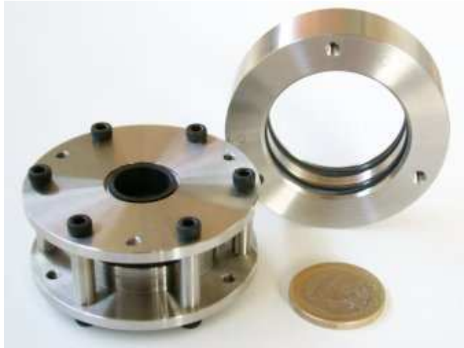
FIG. L.1 – Coupleur avec une fente annulaire en paroi.
