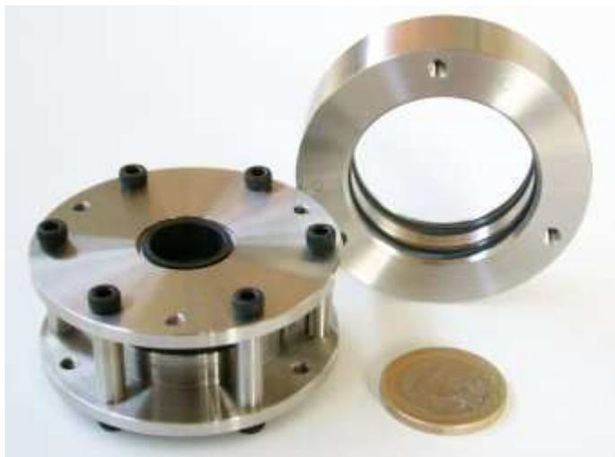
FIG. L.1 – Coupleur avec une fente annulaire en paroi.
