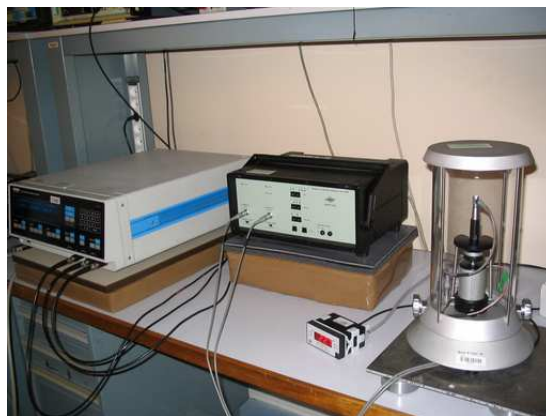
FIG. M.4 – Banc d'étalonnage en usage au LNE (de gauche à droite : l'analyseur vectoriel, l'appareil de réciprocité, l'afficheur de la sonde de température, l'enceinte close contenant les microphones).
