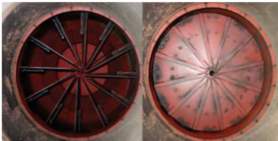
FIGURE 3.3. – Système de pâles permettant d'ajuster la vitesse d'écoulement dans la veine d'essai, en ouverture (gauche) et fermeture (droite) maximales (Morilhat, 2018)
