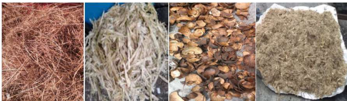
FIGURE 1.4 – Quelques exemples de déchets séchés (de la gauche vers la droite, déchets de rotin, bagasse de canne à sucre, coques de noix de coco et pelures d'ananas) [31, 34]
