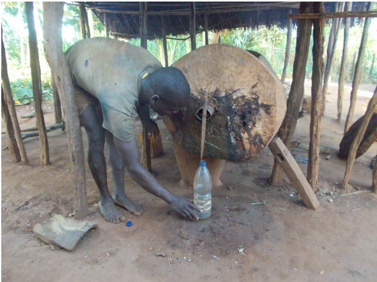
Figure 7.14.3: Photographie d'un site de distillation de canne à sucre. La canne fermentée dans de l'eau est chauffée dans un bidon en métal placé de l'autre côté du tronc d'arbre creusé. Les vapeurs d'eau et d'alcool sont concentrées dans un tuyau de métal qui traverse le tronc. Elles sont refroidies par l'eau placée dans le tronc creusé et coulent dans des bouteilles en plastique le long de la tige en bambou. Photographie N. Leblond, 2015.
