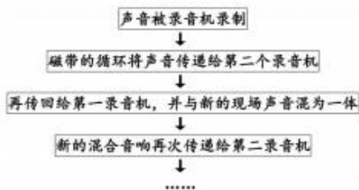
图2 回射循环的工作原理
