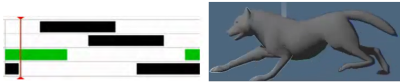
FIGURE 5.7 : Cycle de locomotion : les barres représentent la phase de vol des quatre pattes. L'utilisateur édite la barre verte pour changer la synchronisation avec les autres pattes et le temps de vol. Source : [Kar+11]
