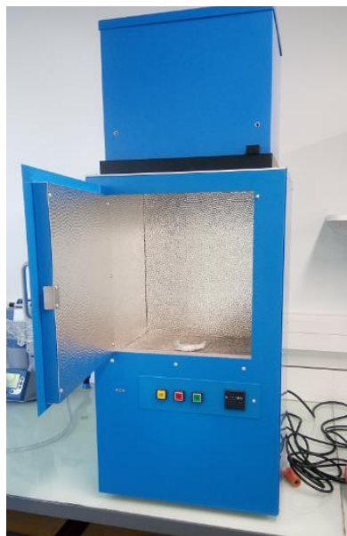
Figure II. 10. Chambre d'irradiation UV (UVACUBE 400) utilisée pour étudier l'activité photocatalytique des échantillons.
