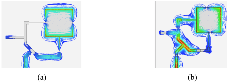
Figure 125. Représentation du champ électrique. (a) État OFF. (b) État ON [58].
