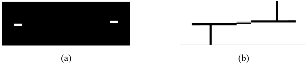
Figure 103. Masques du filtre interdigités. (a) Masque du dopage. (b) Masque de la métallisation.
