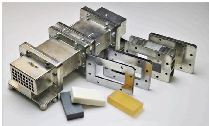
Figure 11. Cellule de caractérisation et dispositifs de calibration TRL en bande S [17].
