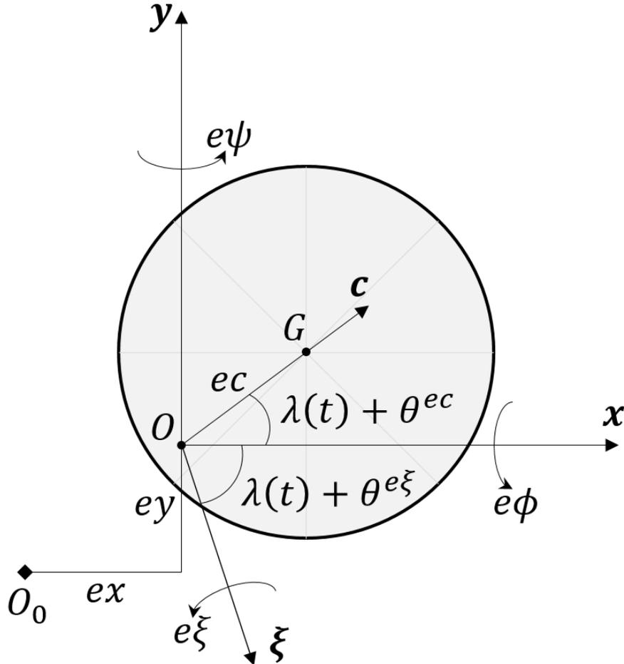
Figure 2-5 Représentation des erreurs d'assemblage d'un engrenage cylindrique, avec  $G$  centre géométrique de l'engrenage,  $O$  centre de rotation instantané réel de l'engrenage, et  $O_0$  centre de rotation instantané théorique et centre géométrique de l'engrenage en absence d'erreurs d'assemblage
