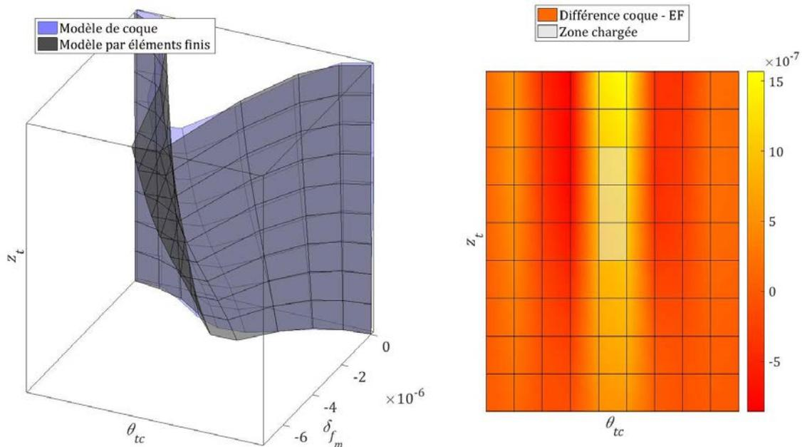
Figure 3-8 Comparaison des résultats de déflexion normale (en m) du modèle de coque et du modèle par éléments finis aux points de mesure pour le quatrième cas de chargement
