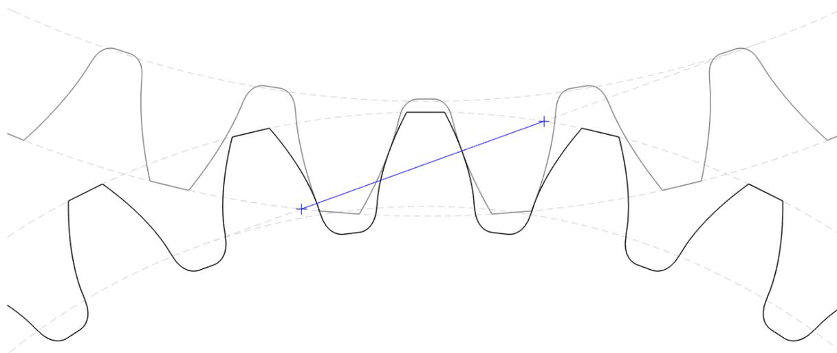
Figure 1-1 Plan d'action et profils théoriques d'engrenages cylindriques
