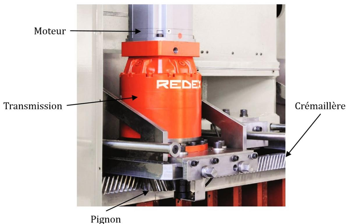
Figure 1-4 Exemple de transmission pour machine-outil
