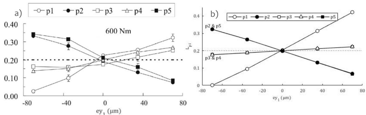
Figure 3-18 Facteurs de partage de charge entre satellites  $L_{pi}$  pour différentes erreurs de position du satellite n°1 a) mesurés [12] et b) obtenus par simulation pour un couple d'entrée de 600Nm et une vitesse de rotation en entrée de 500rpm
