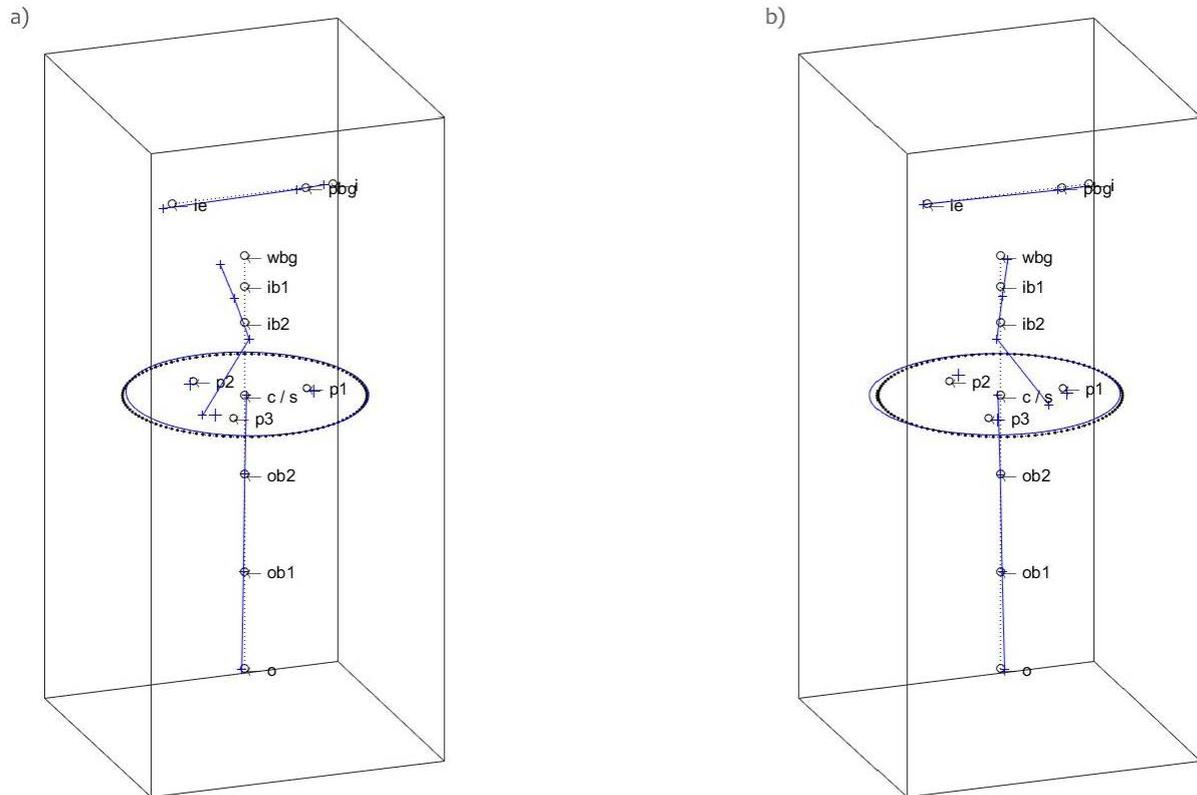
Figure 4-20 Déformées modales du mode 5 en sens de rotation a) horaire et b) trigonométrique.
