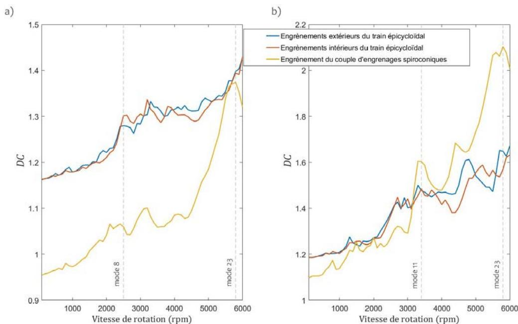
Figure 4-24 Evolution du coefficient de surcharge dynamique  $DC$  dans le sens de rotation a) horaire et b) trigonométrique, pour les engrenements extérieurs (planétaire/satellites) et les engrenements intérieurs (satellites/couronne) du train épicycloïdal, et l'engrenement du couple d'engrenages spiroconiques
