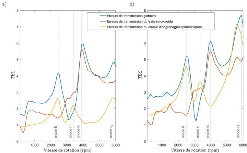
Figure 4-25 Evolution du coefficient d'erreurs de transmission  $TEC$  dans le sens de rotation a) horaire et b) trigonométrique, pour le système global, pour les engrènements du train épicycloïdal uniquement et pour l'engrènement du couple d'engrenages spiroconiques
