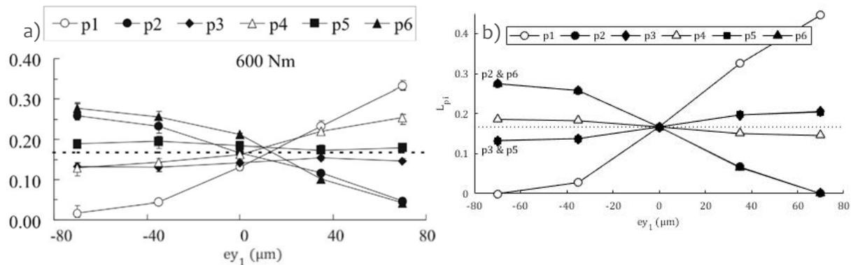
Figure 3-19 Facteurs de partage de charge entre satellites  $L_{pi}$  pour différentes erreurs de position du satellite n°1 a) mesurés [12] et b) obtenus par simulation pour un couple d'entrée de 600Nm et une vitesse de rotation en entrée de 500rpm
