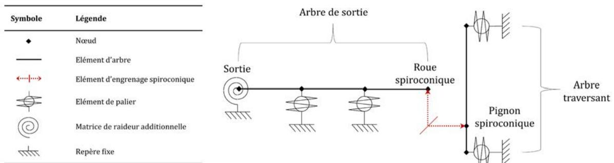
Figure 4-1 Architecture du modèle sans train épicycloïdal
