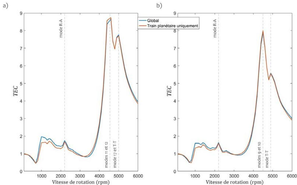
Figure 4-12 Evolution du coefficient d'erreurs de transmission  $TEC$  dans le sens de rotation a) horaire et b) trigonométrique, pour le système global (erreurs de transmission prises entre les nœuds d'entrée et de sortie) et pour l'engrènement uniquement (erreurs de transmission prises entre les nœuds du planétaire et du porte-satellites uniquement)
