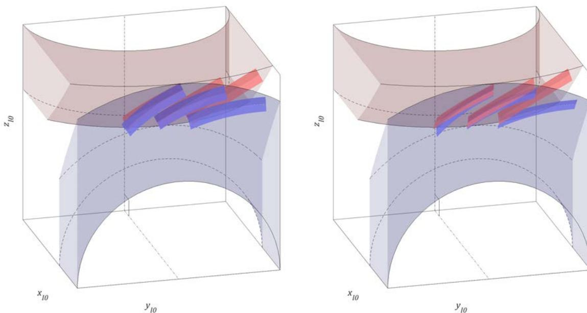
Figure 2-10 Représentation des surfaces de denture et des cônes primitifs d'un pignon (en bleu) et d'une roue (en rouge) conique présentant un angle entre axes de  $90^\circ$ , dans le repère commun  $R_{I0}$ , pour les deux sens de rotation
