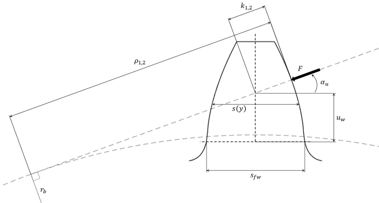
Figure 1-7 Paramètres géométriques de la formulation de Weber
