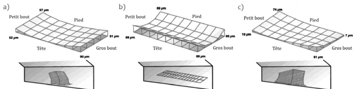
Figure 1-13 Distances de correction et portées résultantes de l'application d'une correction a) longitudinale b) de profil c) du flanc en vrille [39]
