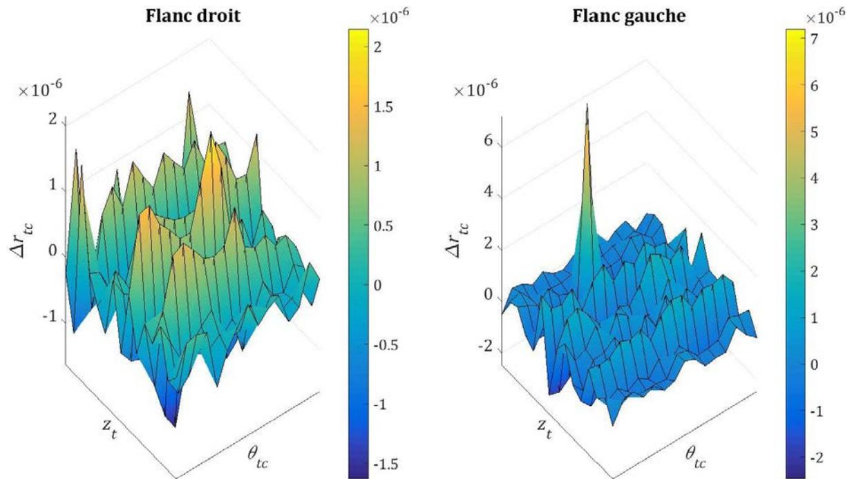
Figure 3-11 Différence de position selon  $e_r$ , dans le repère local cylindrique  $R_{tc}$ , entre points mesurés sur le flanc de denture et points approximatés pour le pignon spiroconique, en mètres
