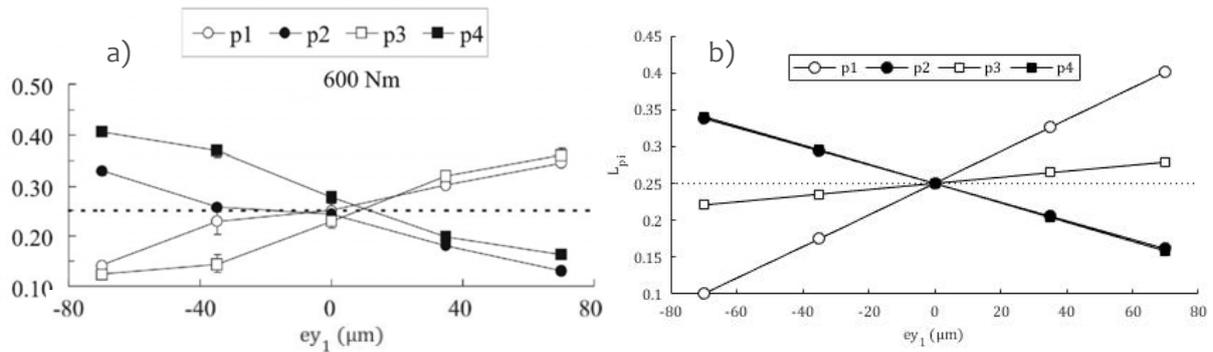
Figure 3-17 Facteurs de partage de charge entre satellites  $L_{pi}$  pour différentes erreurs de position du satellite n°1 a) mesurés [12] et b) obtenus par simulation pour un couple d'entrée de 600Nm et une vitesse de rotation en entrée de 500rpm
