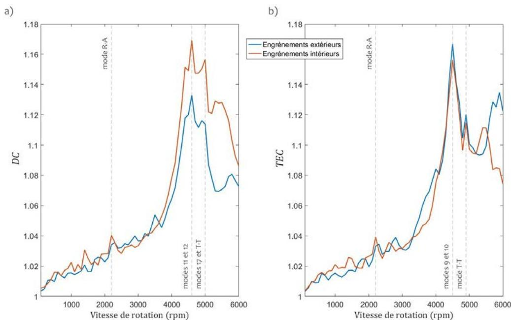
Figure 4-11 Evolution du coefficient de surcharge dynamique  $DC$  dans le sens de rotation a) horaire et b) trigonométrique, pour les engrènements extérieurs (planétaire/satellites) et les engrènements extérieurs (satellites/couronne)
