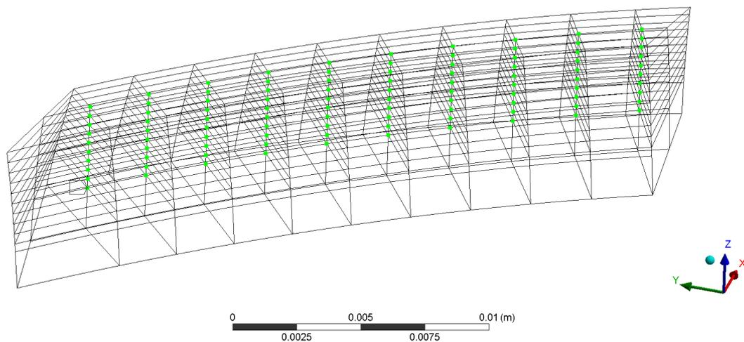
Figure 3-3 Géométrie de la dent dans le repère  $R_{tc}$ , avec ■ représentant les points de mesure sur la fibre neutre, aux intersections avec les sections selon  $e_\theta$  et  $z_t$
