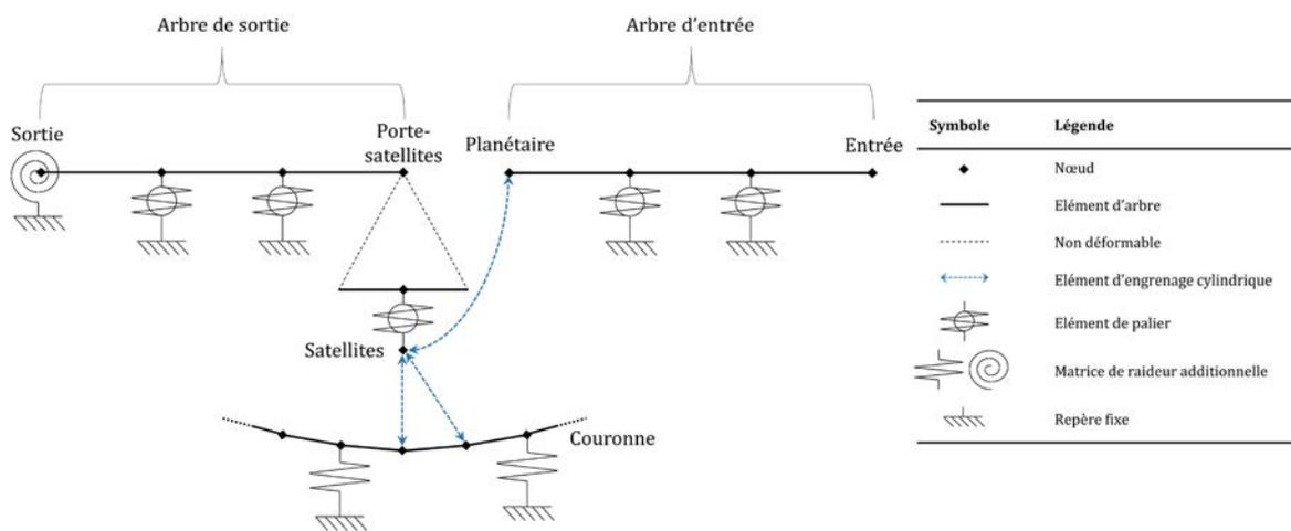
Figure 4-7 Architecture du modèle sans couple d'engrenages spiroconique
