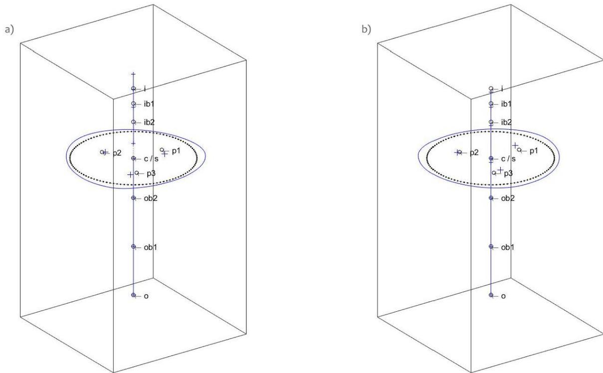
Figure 4-8 Déformées modales a) du mode 10 en sens de rotation horaire et b) du mode 8 en sens de rotation trigonométrique. Légende : o - position nominale des nœuds, + - position déformée des nœuds, i : nœud d'entrée, ib1, ib2 : nœuds des roulements de l'arbre d'entrée, c / s : nœuds du porte-satellites et du planétaire (deux nœuds différents mais géométriquement superposés), ob1, ob2 : nœuds des roulements de l'arbre de sortie, o : nœud de sortie, p1, p2, p3 : nœuds des satellites
