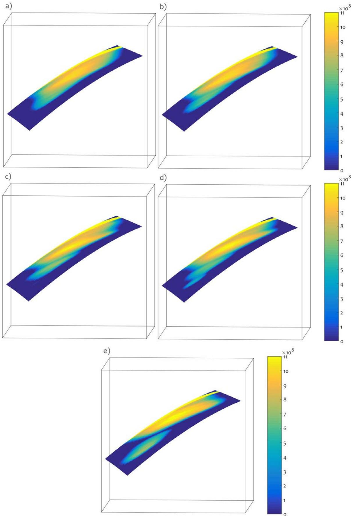
Figure 4-26 Répartition des pressions de contact (en Pascal) sur le flanc de denture du pignon spi-roconique à a) 100rpm, b) 250rpm, c) 330rpm, d) 440rpm et e) 560rpm en sens de rotation trigonométrique
