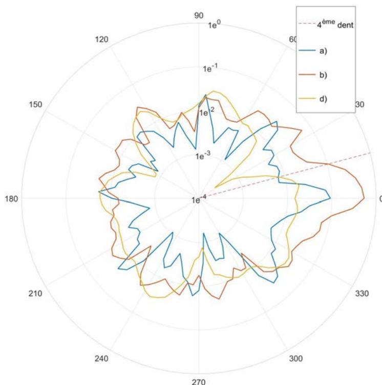
Figure 4-19 Amplitude ( $m/s^2$ ) de la quéfrence d'apparition du défaut (cas a) et b) :  $q=36$ , cas d) :  $q=8$ ) en fonction de la position angulaire sur la couronne du point de calcul des accélérations radiales ( $^\circ$ )
