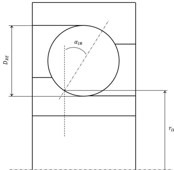
Figure 2-14 Paramètres géométriques des roulements à billes
