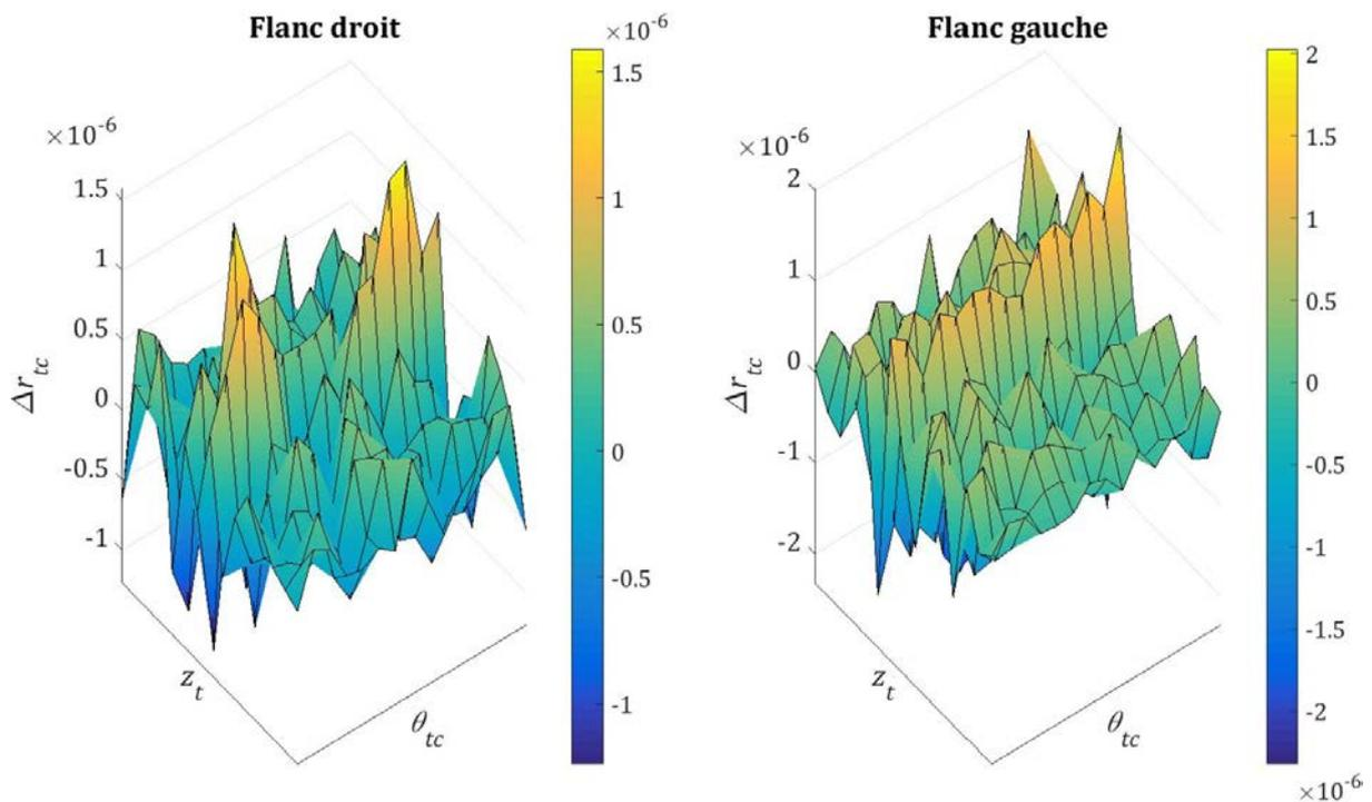
Figure 3-12 Différence de position selon  $e_r$ , dans le repère local cylindrique  $R_{tc}$ , entre points mesurés sur le flanc de denture et points approximatés pour la roue spiroconique, en mètres
