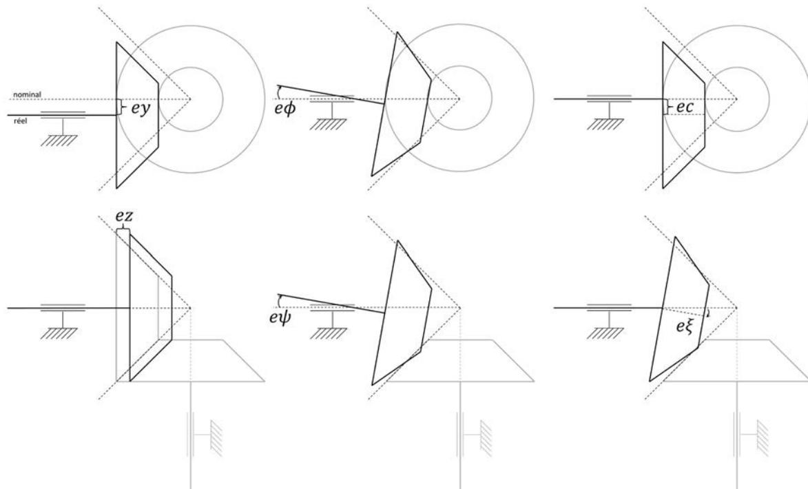
Figure 2-11 Représentation des erreurs d'assemblage d'un engrenage spiroconique
