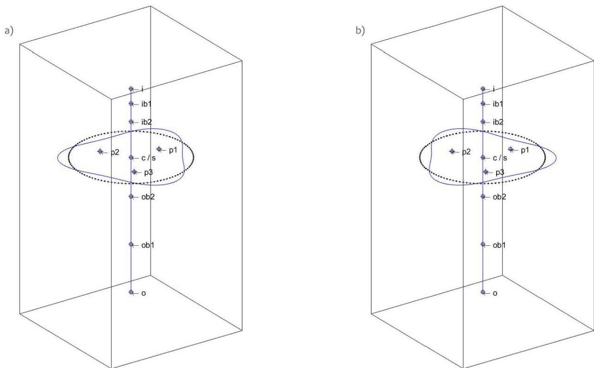
Figure 4-10 Déformées modales du mode 28 pour le sens de rotation a) horaire et b) trigonométrique, une légende détaillée de cette représentation est donnée en figure 4-8
