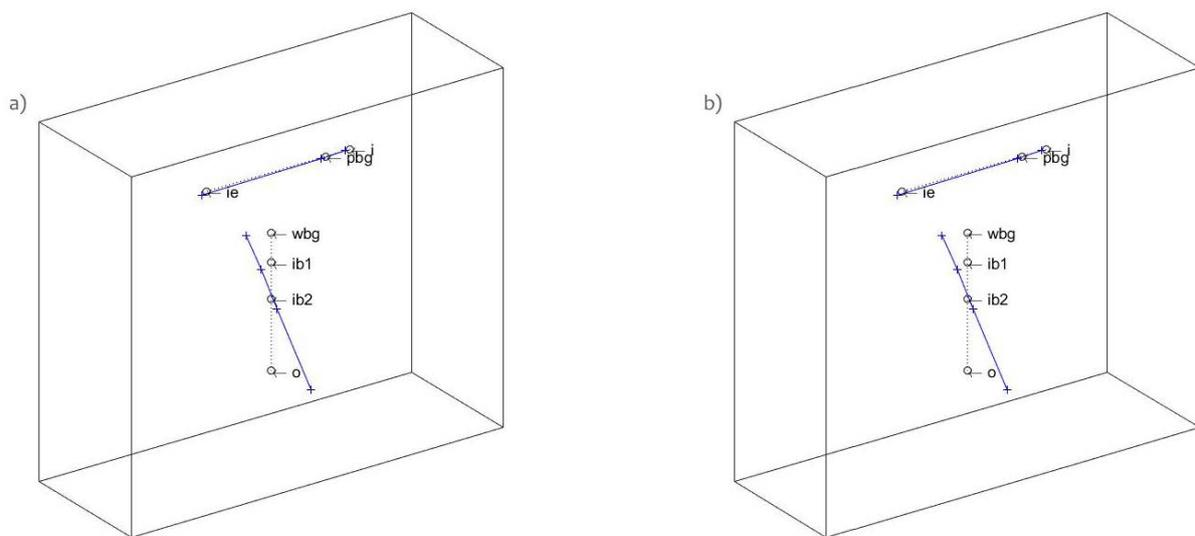
Figure 4-2 Déformées modales du premier mode des sens de rotation a) horaire et b) trigonométrique. Légende :  $\circ$  - position nominale des nœuds,  $+$  - position déformée des nœuds,  $i$  : nœud d'entrée et du premier roulement de l'arbre traversant,  $pbj$  : nœud du pignon spiroconique,  $ie$  : nœud du second roulement de l'arbre traversant,  $wbg$  : nœud de la roue spiroconique,  $ib1, ib2$  : nœuds des roulements de l'arbre de sortie,  $o$  : nœud de sortie
