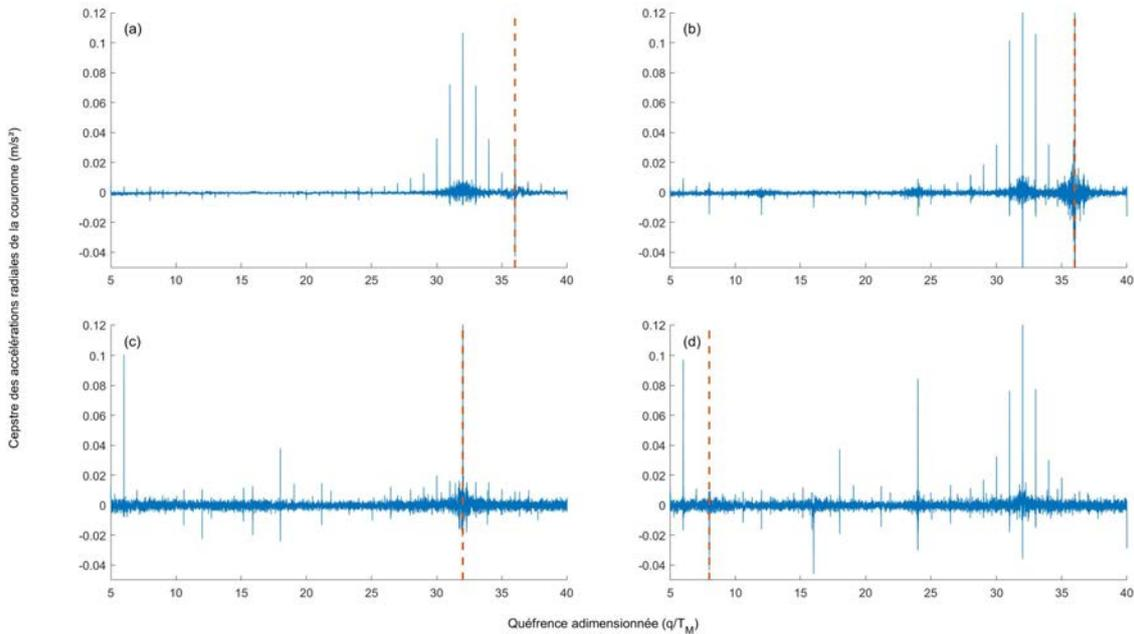
Figure 4-18 Cepstres des accélérations radiales de la couronne des configurations a), b), c) et d) à la quéfrencé d'apparition du défaut (--- Quéfrencé d'apparition du défaut)
