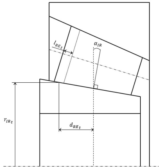
Figure 2-15 Paramètres géométriques des roulements à rouleaux coniques
