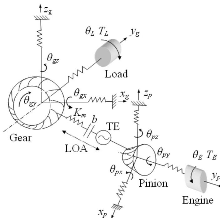
Figure 1-17 Modèle à paramètres concentrés de Peng [109]
