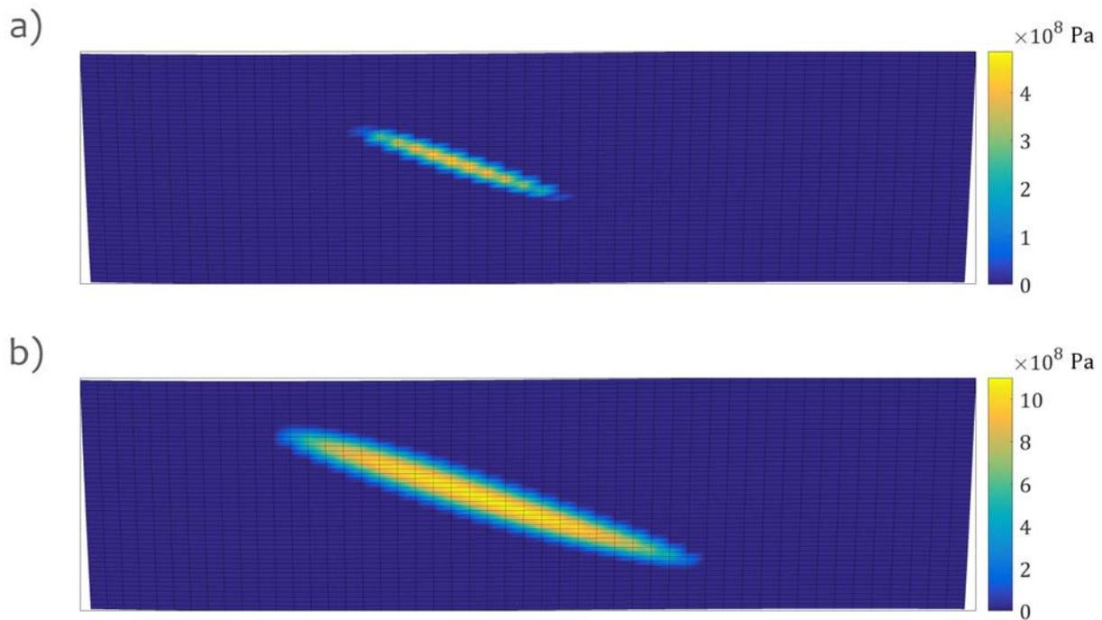
Figure 3-2 Pressions de contact obtenues par le modèle sur le flanc du pignon pour a) un couple de 20Nm b) un couple de 200Nm sur le pignon
