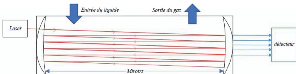
Figure 78 : Schéma du principe de fonctionnement de la méthode OA-ICOS.
