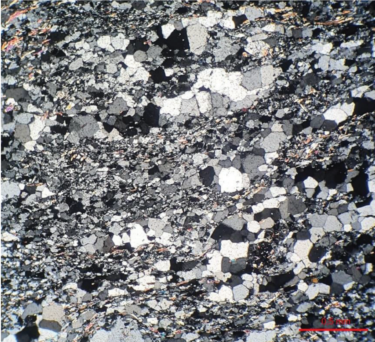
Figure 105: Vue en lame mince de l'échantillon 9MB52, la texture du quartz présente un degré de recrystallisation important, en rotation de sous grain (SGR).
