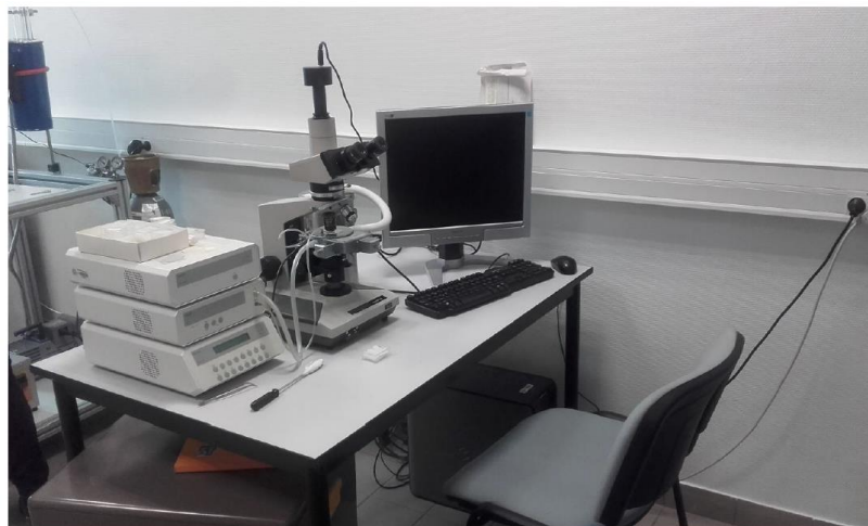
Figure 46 : Installation micro-thermométrique du laboratoire de Géologie de Lyon (Géode). Platine chauffante/réfrigérante Linkam Inc. THM 600 couplée à un microscope optique (Nicolas, 2018).
