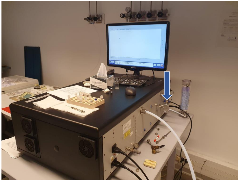
Figure 77 : Photo de l'analyseur isotopique IWA-45EP. L'eau est injectée dans le septum située sur la partie droite de l'analyseur sur la photo (flèche bleue).
