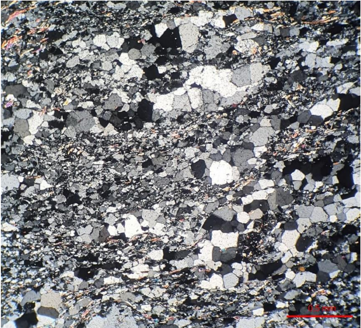
Figure 105: Vue en lame mince de l'échantillon 9MB52, la texture du quartz présente un degré de recristallisation important, en rotation de sous grain (SGR).
