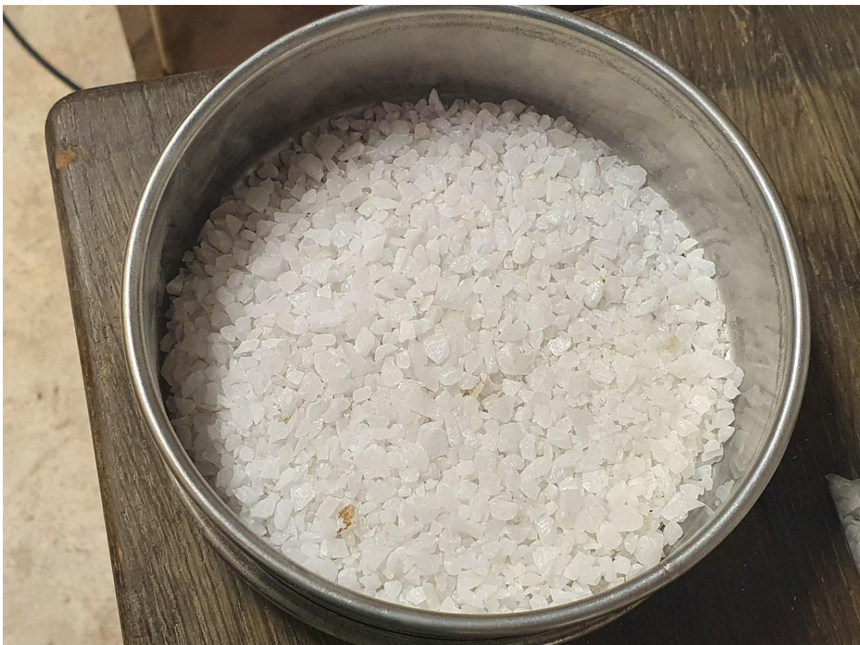
Figure 73 : Grains de quartz tamisés une première fois (0,5 à 10 mm). Cette couleur blanche opaque des grains indique généralement qu'ils contiennent une quantité relativement importante d'IFs.
