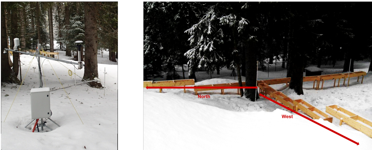
FIGURE 25 – Dispositif expérimental de la campagne SNOUF dans la forêt du Col de Porte : station météorologique automatique mesurant les flux radiatifs sous la canopée et dispositif de mesure de la neige interceptée par les arbres
