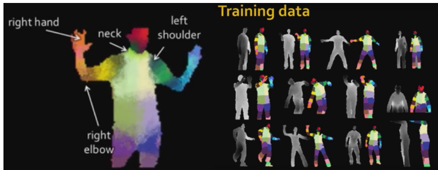
FIGURE 5.22 – Labelisation des différentes parties du corps et dataset utilisée pour l'apprentissage de la détection de la pose humaine.
