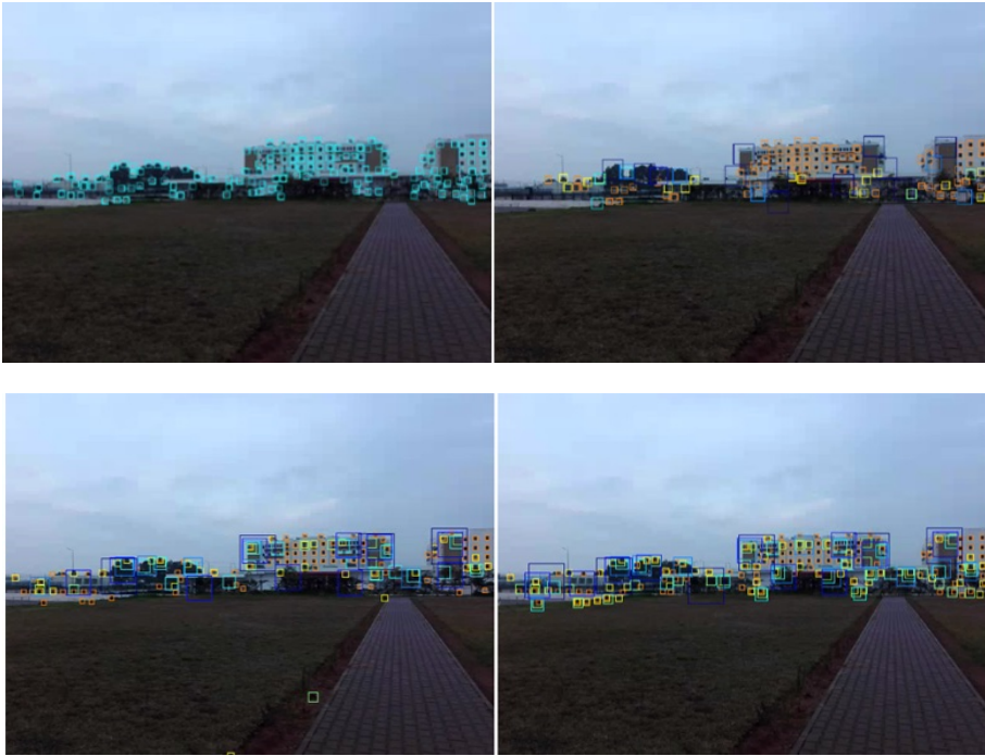
FIGURE 2.3 – Comparaison de détecteurs. Première ligne : Harris et Harris Laplace. Deuxième ligne : Hessian Laplace et LoG
