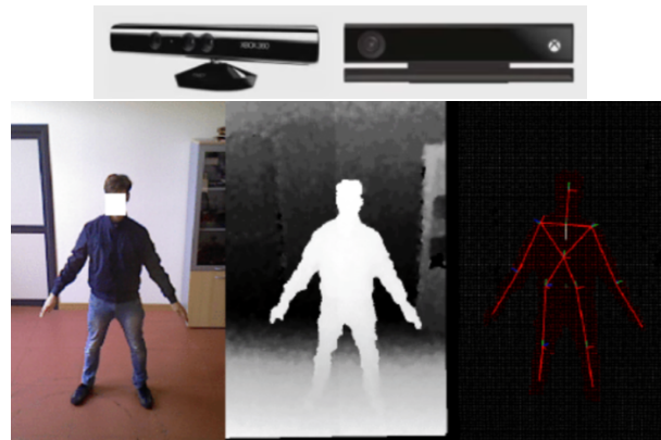
FIGURE 5.12 – Première ligne : deux versions de la Kinect. Deuxième ligne : image RGB, carte de profondeur et détection de la pose humaine.
