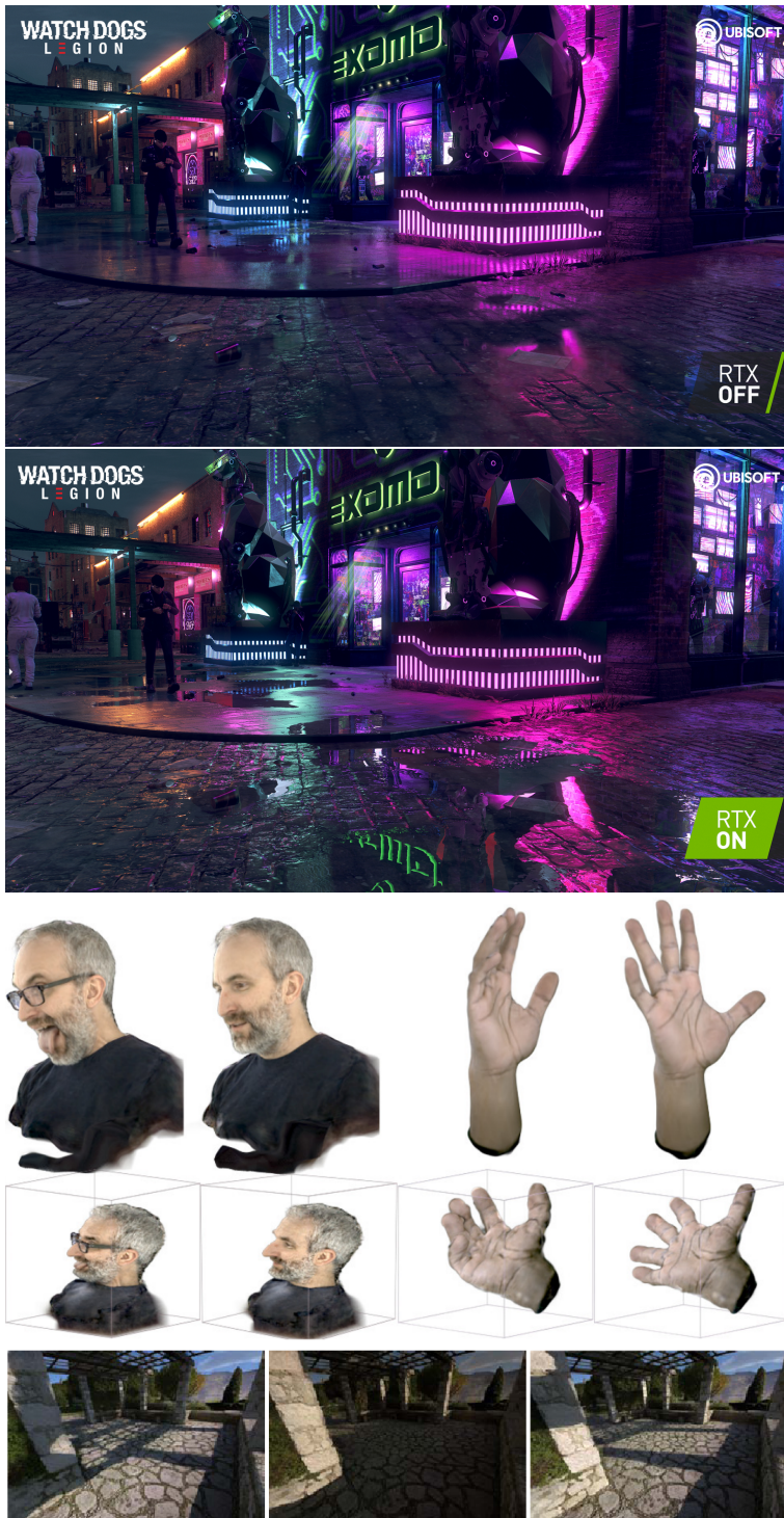
FIGURE 5.1 – Rendu d'images de synthèse par rasterisation (première ligne), par Ray Tracing (deuxième ligne) et par "Neural Rendering" pour la synthèse de nouvelle vue (troisième ligne) et pour la synthèse de nouvelle position d'éclairage (quatrième ligne).
