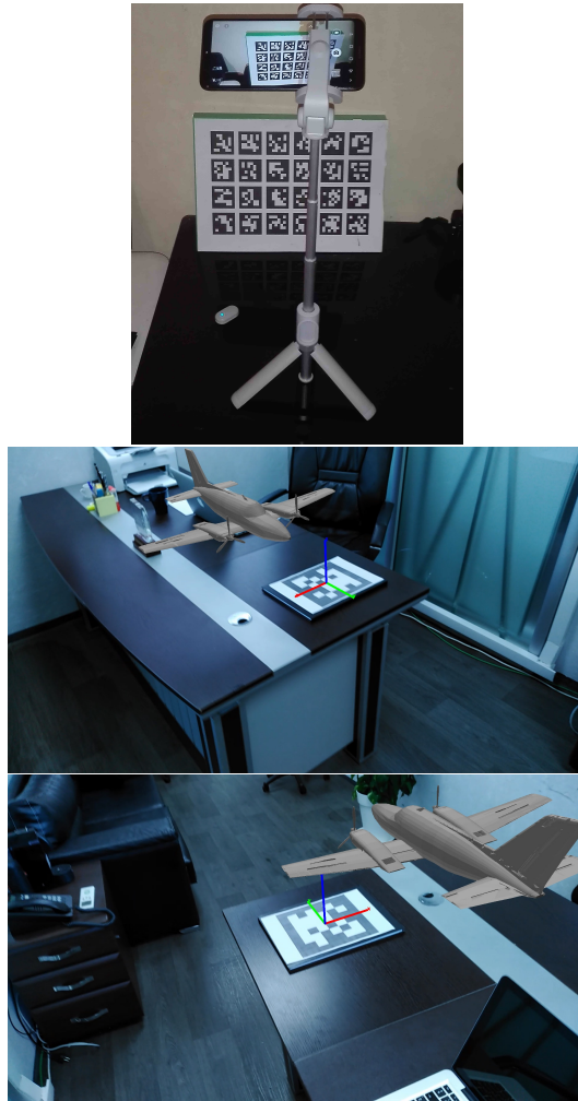
FIGURE 7.17 – (a) : Configuration de la calibration de la caméra. (b) : Résultat de la projection d'un objet 3D dans une vidéo acquise avec une caméra mobile
