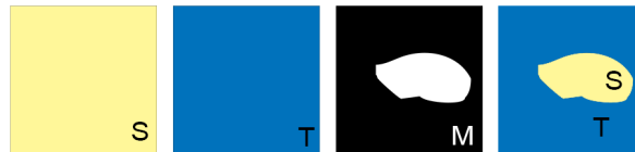
FIGURE 6.4 – Illustration de la composition de régions d'images S et T à l'aide d'un masque M .
