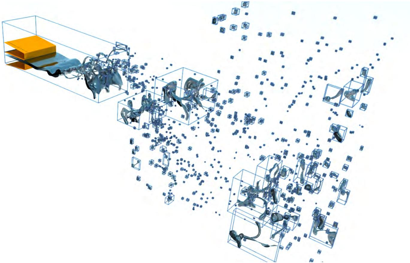
FIGURE 6.3. – Détection des structures liquides générées durant une simulation d’atomisation.
