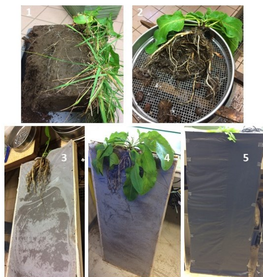
Figure 29. Étapes de la mise en place d'une plante entière dans un rhizotron, exemple de R. acetosa .
