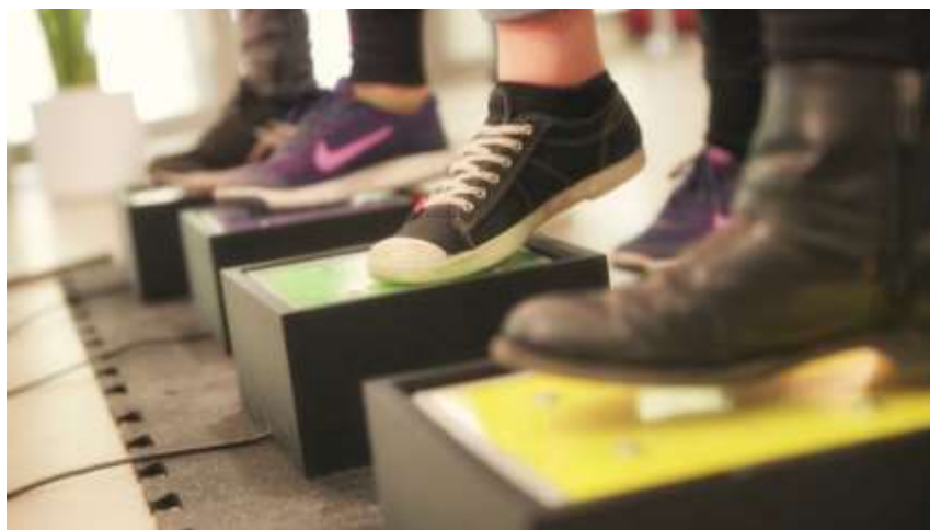
Figure 220. Les boutons utilisent une couleur vive issue d'un papier vinyle, parfaitement visible en pleine lumière du jour.
