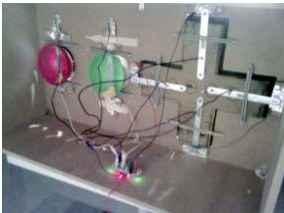
Figure 71. Carte Makey-Makey branchée à des boutons géants. Elle permet de transformer le signal en appui de clavier. Elle a servi pour le prototype de la manette du jeu Super (voir Chapitre 4.3) et pour le jeu Coin-coin contre Minou (voir Chapitre 3.3).
