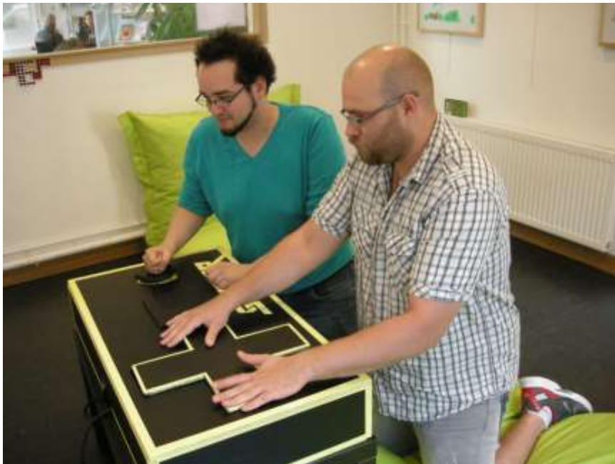
Figure 186. Deuxième version de la manette. Moins épaisse, avec des couleurs et un seul bouton en ON/OFF.
