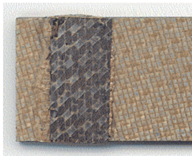
Figure V-36 : Epreuve soudée avec une grille double suivant la direction x
