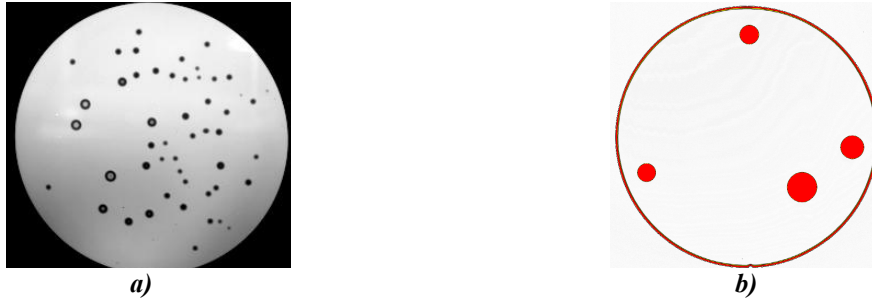
figure 24 : Caractérisation infra rouge de deux collages a) à pression ambiante ou b) sous vide, qui ont subis un recuit long à 400°C.
