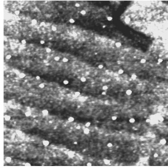
figure 4 : Caractérisation AFM (500nm*500nm) d'une surface de silicium après le retrait de l'oxyde natif par du HF vapeur. L'oxyde natif avait préalablement été nettoyé.
