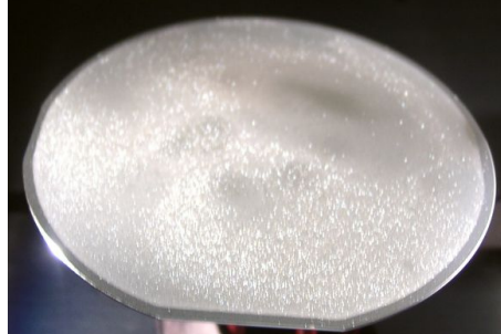
figure 36 : Caractérisation en lumière rasante du transfert par Smart Cut™ d'un film mince de silicium avec un collage hydrophobe avec des substrats de 100mm de diamètre. Aucun film n'est transféré.
