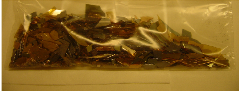
figure 59 : Sachet en plastique contenant les restes d'un collage silicium/silice fondue recuit à une température trop importante!!!!!!
