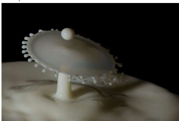
(c) Format d'un film liquide avec apparition de digitations après l'impact d'une goutte dans une flaque de lait.
