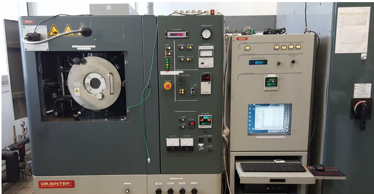
Figure 1 : Machine SPS Syntex 2080 de Toulouse
