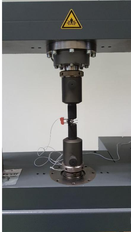
Figure 5 : Système de traction de la machine Zwick Roell Z030
