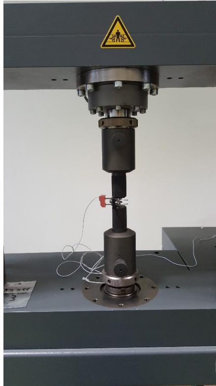
Figure 5 : Système de traction de la machine Zwick Roell Z030
