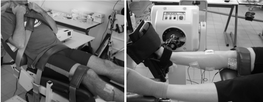
Figure 26 : Position du sujet sur le dynamomètre isocinétique (angles de la hanche, du genou et de la cheville fixés à 40^\circ , 180^\circ et 15^\circ en flexion plantaire respectivement)
