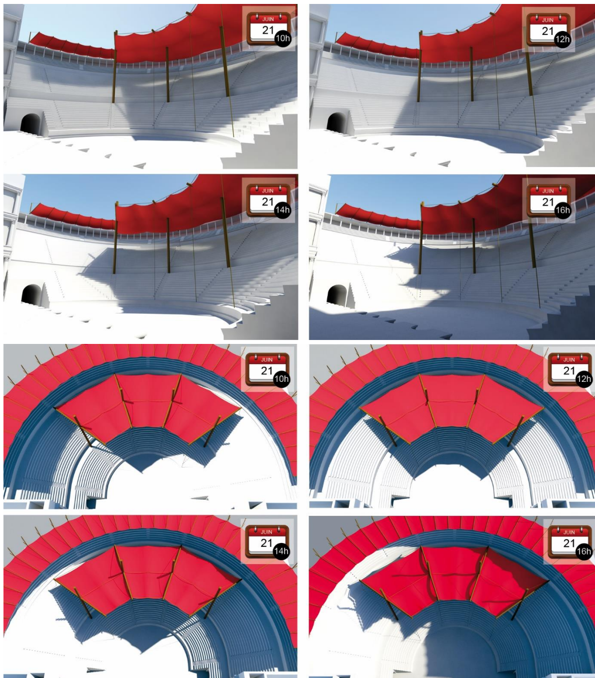
Figure 130 : Solution 1b - Simulation solaire sur le théâtre de Bosra avec un vélum supérieur de 10 m d'envergure et un vélum inférieur de 20 m de portée
