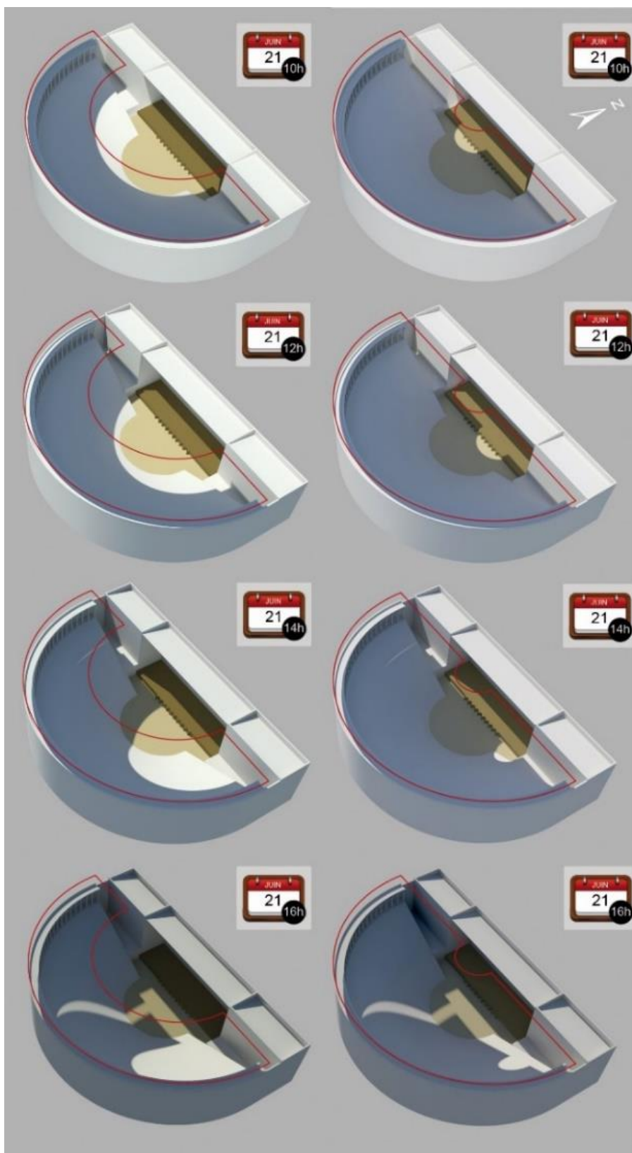
Figure 145 : Comparaison de l'efficacité d'un vélum à vergues de 20 m de portée (à gauche) et d'un vélum à cordes (à droite) sur un théâtre de 300 pieds de diamètre orienté au nord, à la latitude de Rome
