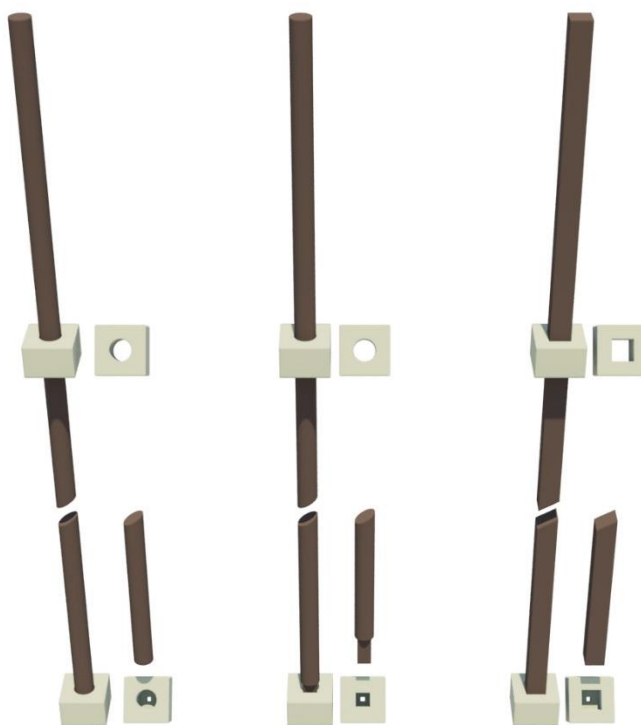
Figure 105 : Trois formes de mât possibles pour soutenir un vélum
