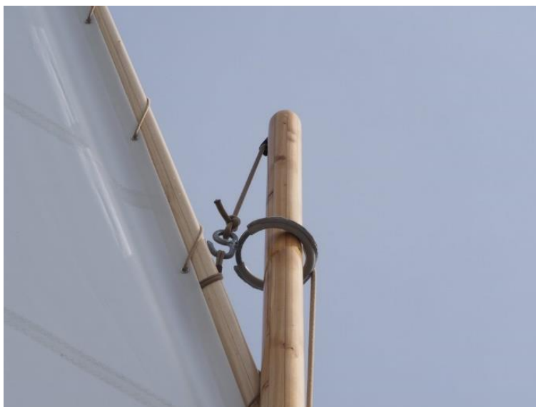
Figure 122 : Une tête de mât avec un rocambeau
