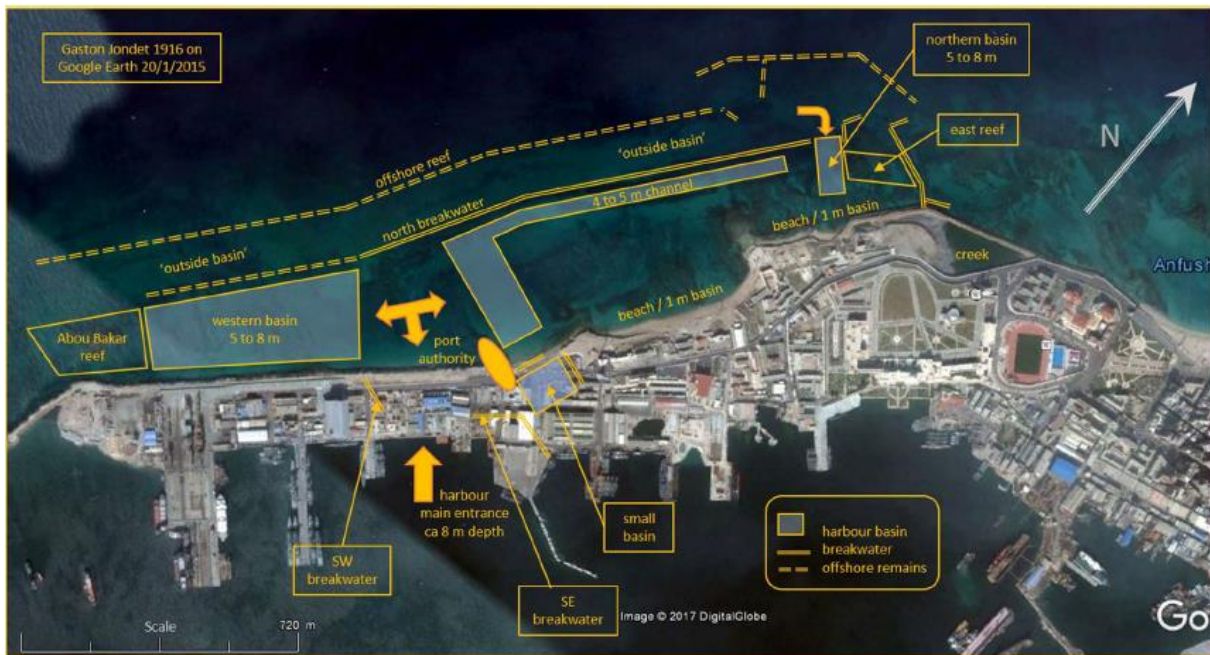
Figure 4. La description par Jondet du port antique de Pharos. (Source : de Graauw, 2022).
