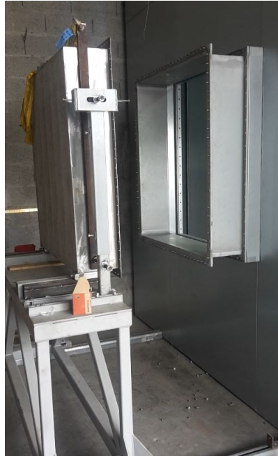
FIGURE 2.1 – Bloc de béton monté sur le chariot roulant, prêt à être boulonné sur la cage de Faraday
