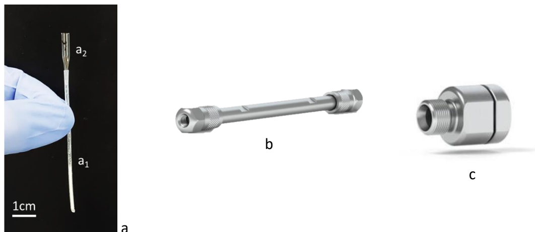
Figure 62 : (a) Photo du remplissage d'un capillaire en PFA ( a_1 ) par de la poudre à l'aide d'un capillaire de type Mark-tube ( a_2 ). (b) Colonne HPLC. (c) Adaptateur « Packing adapter ».
