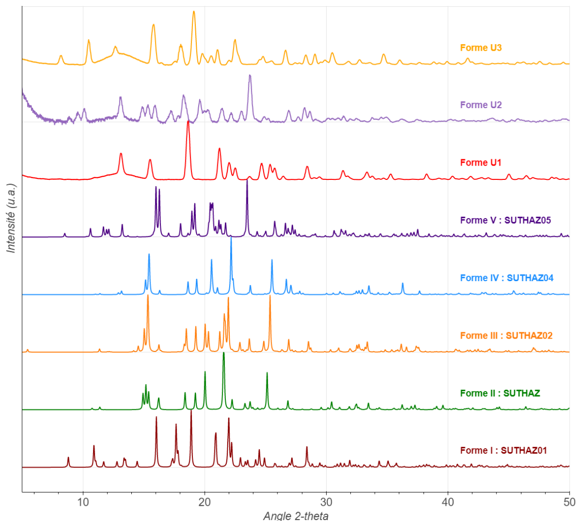
Figure 143 : Diffractogrammes RX des différentes formes cristallines du Sulfathiazole. SUTHAZ, SUTHAZ01, SUTHAZ02, SUTHAZ04 et SUTHAZ05 sont les références issues de la Cambridge Structural Database. U1, U2 et U3 ont été mesurés sur les formes inconnues des cristaux obtenus dans des gouttes d'eau.
