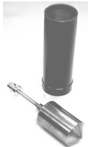
figure 11 : Un rhéomètre avec la cellule de mesure cylindrique
