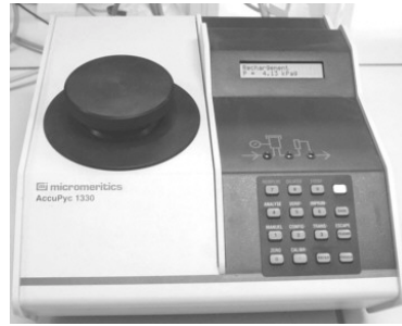
figure 14 : pycnomètre à hélium Micromeritics AccuPyc 1330
