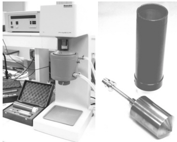
figure 11 : Rhéomètre Physica Rhéolab MC10 avec la cellule de mesure utilisée
