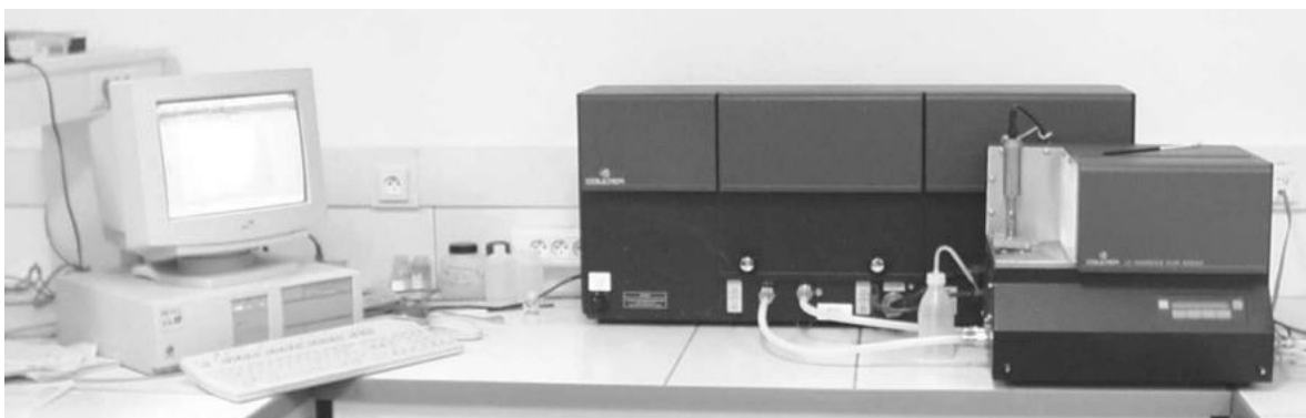
figure 9 : Granulomètre Coulter LS230
