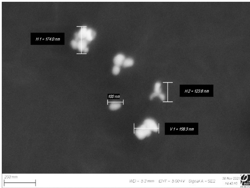
FIGURE 5.3 : Cartographie annotée réalisée au MEB sur l'échantillon S 100 . On y voit plus précisément les petits agrégats constitués par les particules d'oxyde métallique. Ceux-ci semblent contenir entre une et une dizaine de particules pour atteindre des tailles proches de 200 nm.
