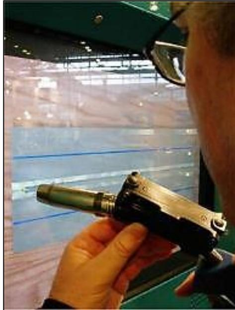
Figure 7. CS WAVE pour l'apprentissage des habiletés motrices de soudage (Mellet-d'Huart, 2006, p. 267).
