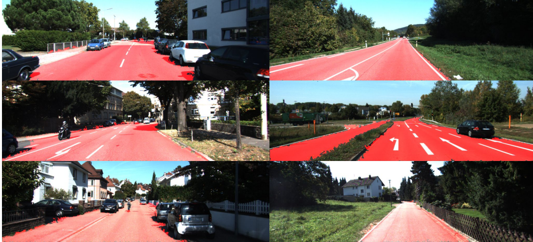
Figure 2.24 - Résultats de détection de la chaussée par couplage de critères d'apparence et de structure dans le jeu de données KITTI-ROAD.
