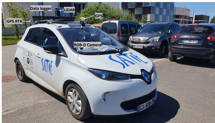
Figure 2.30 - Le véhicule expérimental robotisé pour la perception, la localisation et le contrôle automatique du laboratoire SATIE. Ce véhicule est pourvu des systèmes de vision RGB-D, des récepteurs GNSS RTK et différentiel ainsi qu'un LiDAR et un ordinateur dédié à l'enregistrement et la datation de données.
