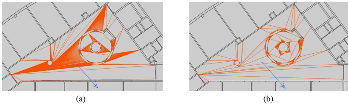
Figure 3.3 – Convexification d’une pièce aux parois courbes : (a) convexification basée sur la méthode présentée par Fernández et al. [44]; (b) application d’un prétraitement permettant une première découpe autour des éléments courbes.
