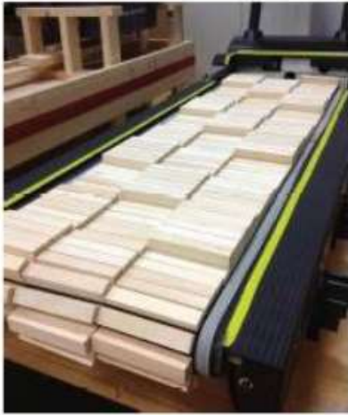
Figure 26 : Tapis roulant équipé de plateforme de forces et de surface irrégulière. D'après [209].
