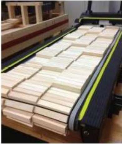
*Figure 26 : Tapis roulant équipé de plateforme de forces et de surface irrégulière. D'après [209].*
