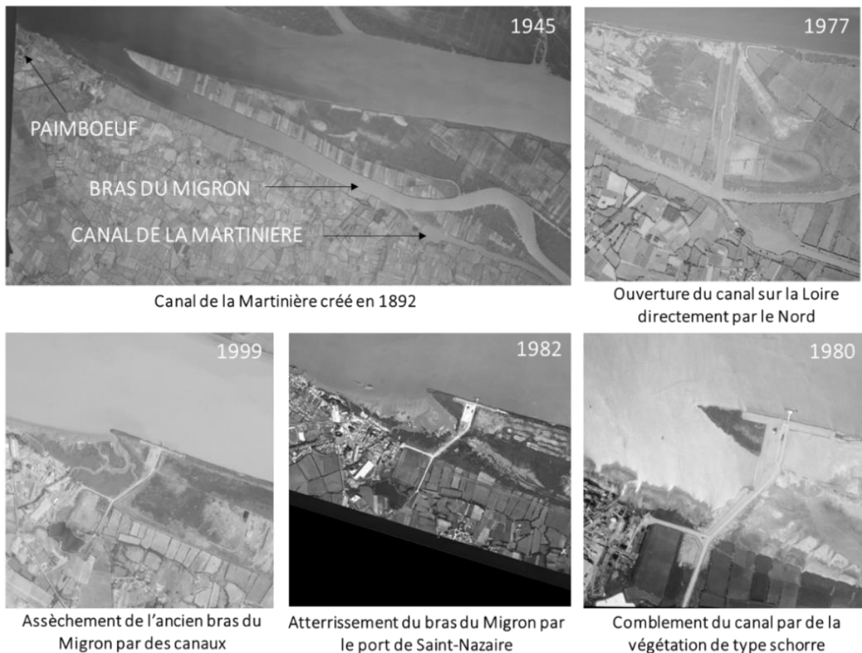
Figure 100 : Fermeture et assèchement de l'entrée du bras du Migron à l'Ouest de Paimboeuf (Source : IGN®)
