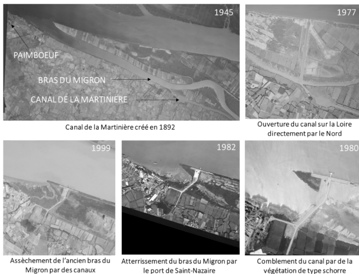
Figure 100 : Fermeture et assèchement de l'entrée du bras du Migron à l'Ouest de Paimboeuf (Source : IGN®)
