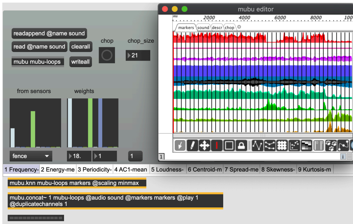
Fig. 10.13 Extrait d'un patch Max pour faire de la synthèse concatenative par descripteur. Dans cette capture, on peut voir le son analysé par 9 descripteurs audio différents et segmenté régulièrement ( chop ) par segments de 21 ms. Dans les paramètres de recherche d'échantillons les plus semblables par l'algorithme de KNN, on va pouvoir donner des poids à chaque descripteur. Dans cet exemple, les descripteurs utilisés sont Frequency , Loudness-mean et Spread-mean . Dans la partie en entrée « from sensors », on va pouvoir mapper différentes données de captation vers les descripteurs sélectionnés avec différentes valeurs pour chercher différents segments de fichiers.
